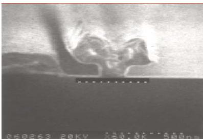
圖1 典型的T型閘極SEM照片
