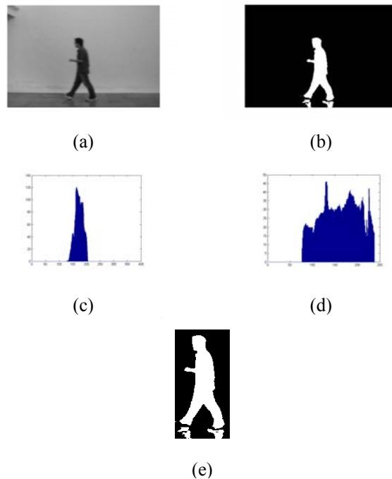
圖一：一個前景影像抽區的範例。(a) 某一影像序列，(b)經由背景模型分析後所得到的二值化影像，(c)二值化影像在垂直方向的投影，(d)二值化影像水平方向的投影，(e)最後所得到的前景二值化影像。
