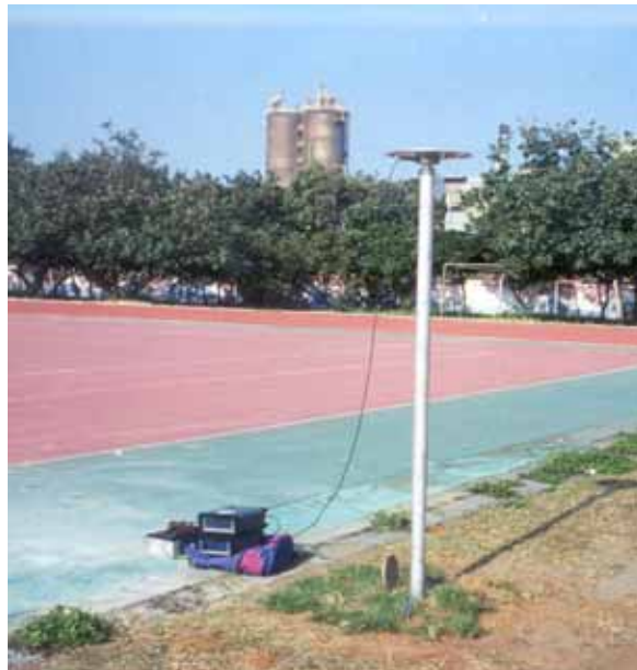
圖 1 強制定心定平 GPS 監測樁
