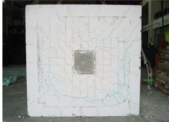
圖六 試體破壞底面照片
