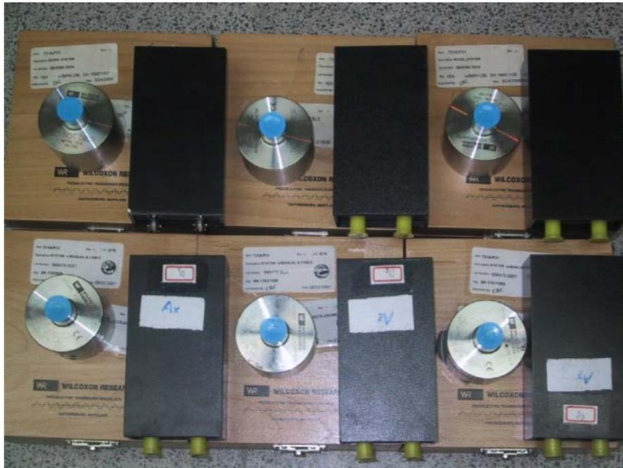
圖 3.11 微振加速規及訊號調節放大器
