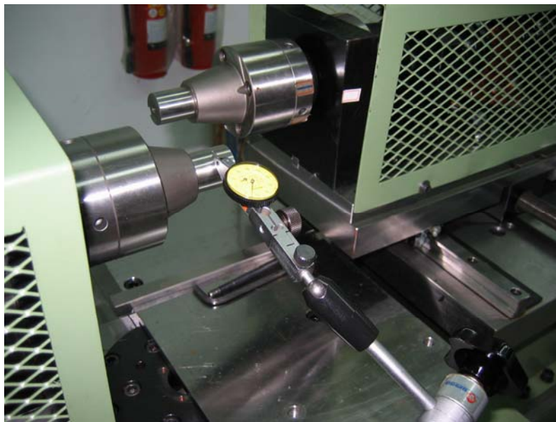
圖 5.5 安裝心軸並校正偏擺
