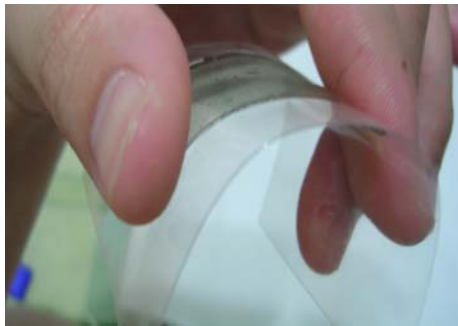
圖一(a) 玻璃基板上之元件經由轉印製程至塑膠基板之元件
