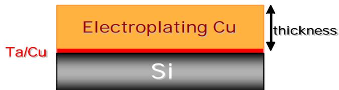
圖 8 退火步驟的實驗試片結構圖
