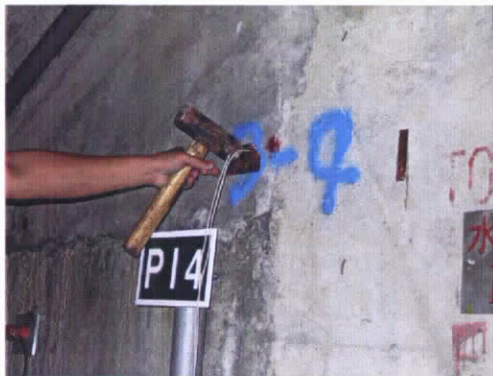
圖 6-38 石門水庫溢洪道下方 SU-R 廊道折射震測採用震源(左)
