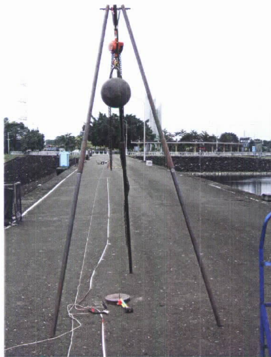
圖 6-74 仁義潭水庫壩頂自由落錘震源施測
