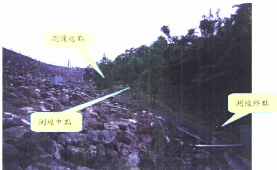
圖 6-66 新山水庫測線 D (左側山脊) 之地電阻施測情形
