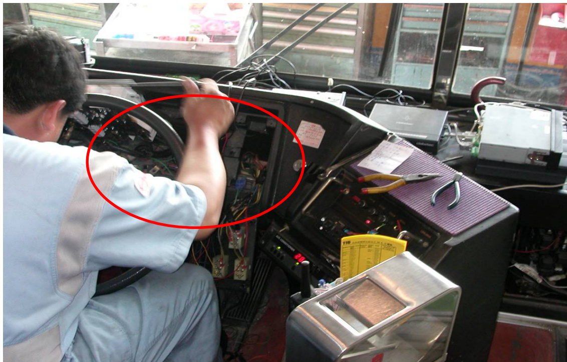
圖 6.3 車機安裝(一):儀表板拆卸
