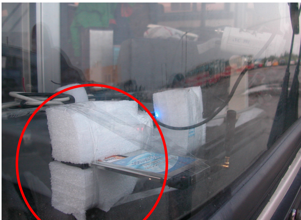
圖 6.21 以泡棉將 CDMA 卡之接槽固定
