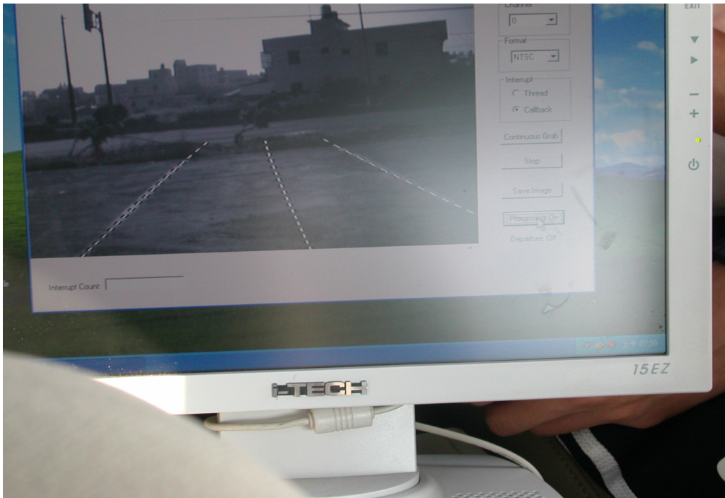
圖 6.16 於面光條件下仍可正確偵測車道線
