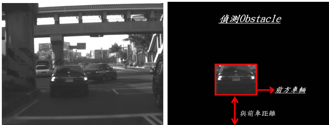
圖 2.21 距離前車過近或旁邊車道有車輛之快速接近警示
