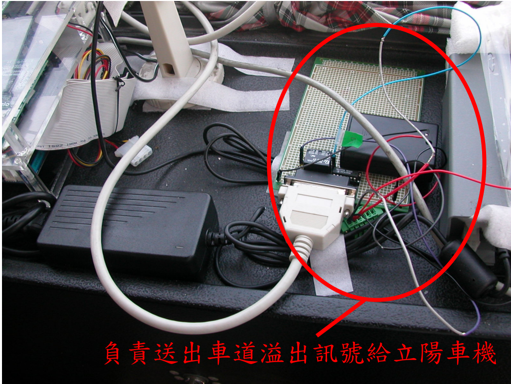
圖 6.11 車道溢出訊號傳送機制
