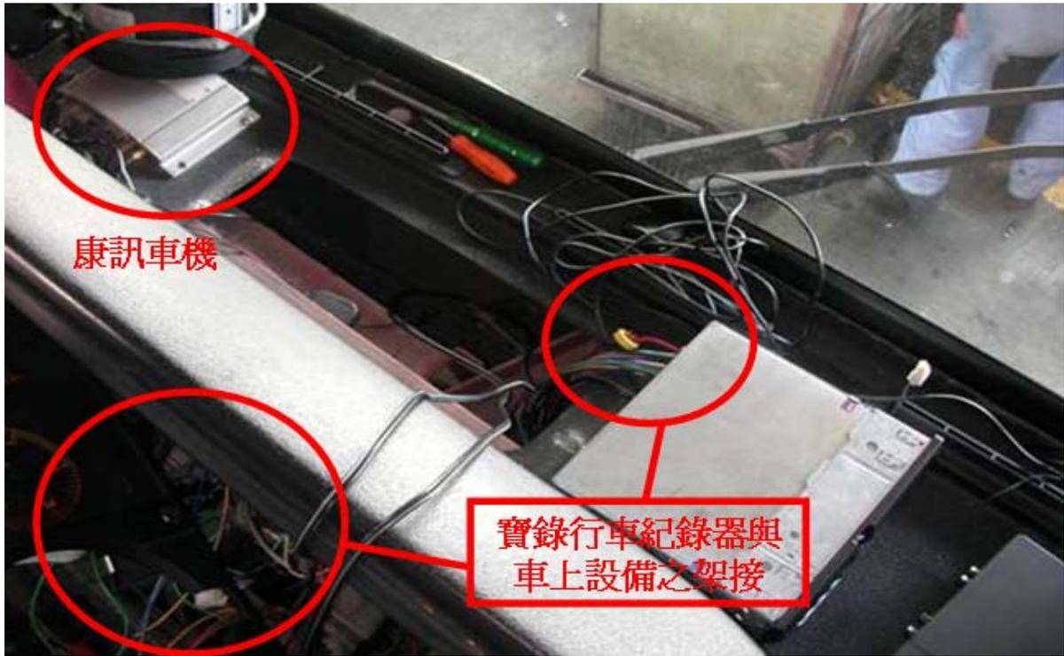
圖 6.4 車機安裝(二): 儀表板後方線路連接
