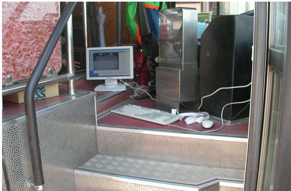
圖 6.23 架設電腦螢幕以利隨車測試之進行
