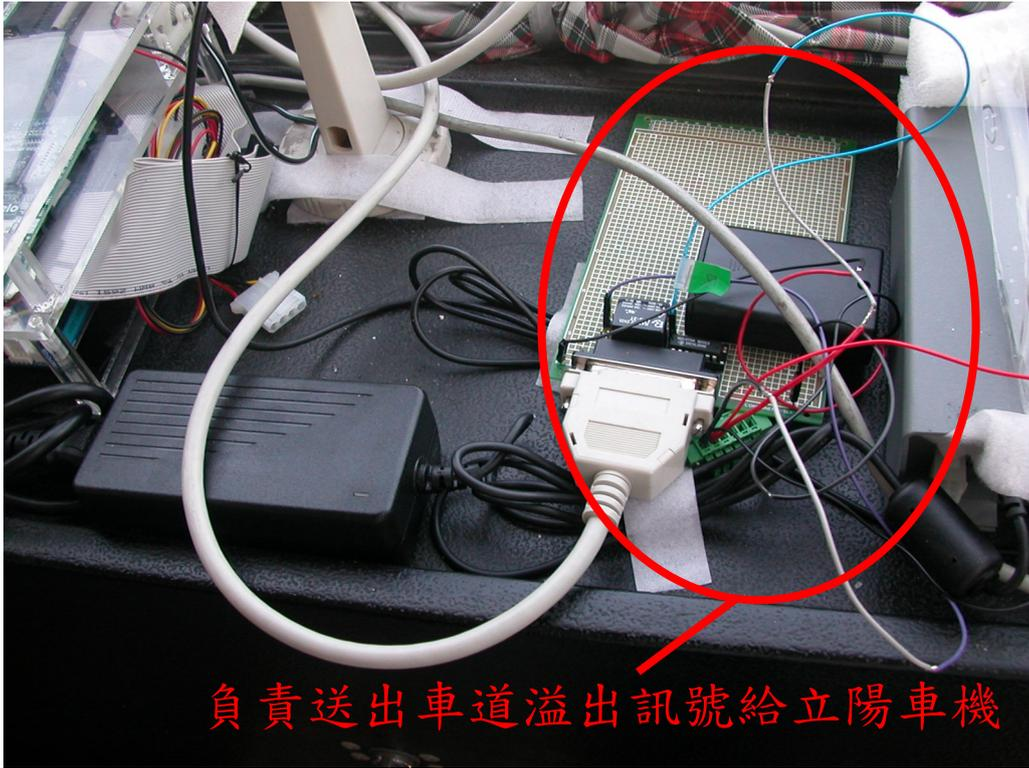
圖 6.11 車道溢出訊號傳送機制
