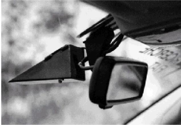
圖 2.11 車道警示輔助系統之 CCD 攝影機
