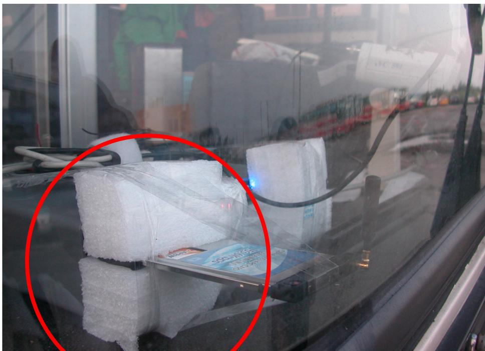
圖 6.21 以泡棉將 CDMA 卡之接槽固定
