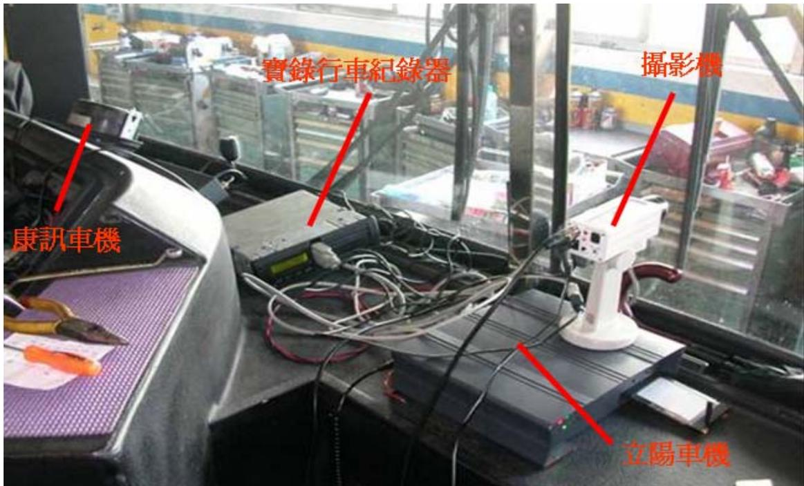
圖 6.7 車機安裝 (五): 整體串接完成
