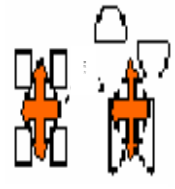
圖 63 微結構受慣性力示意圖
