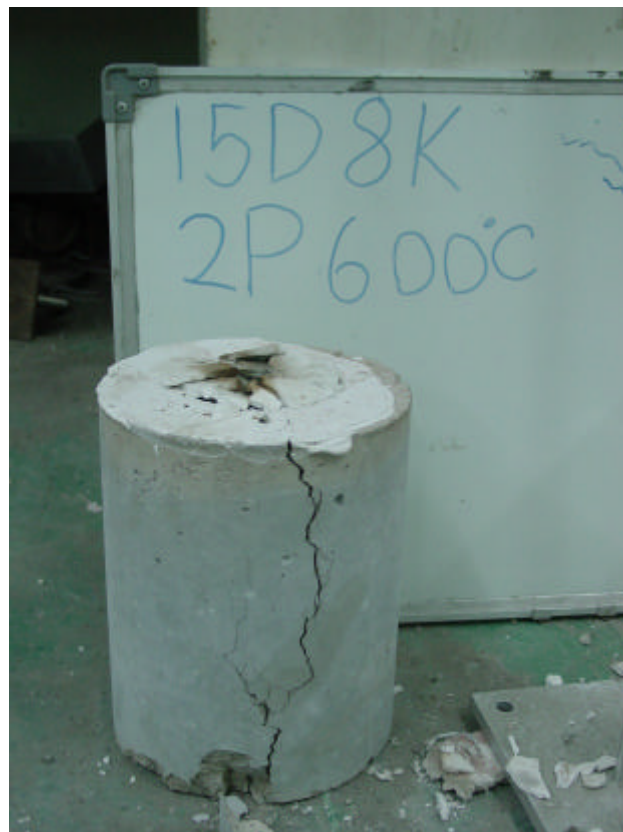
圖(十) 穩態溫度 600 °C 拉拔試驗 試體劈裂情形
