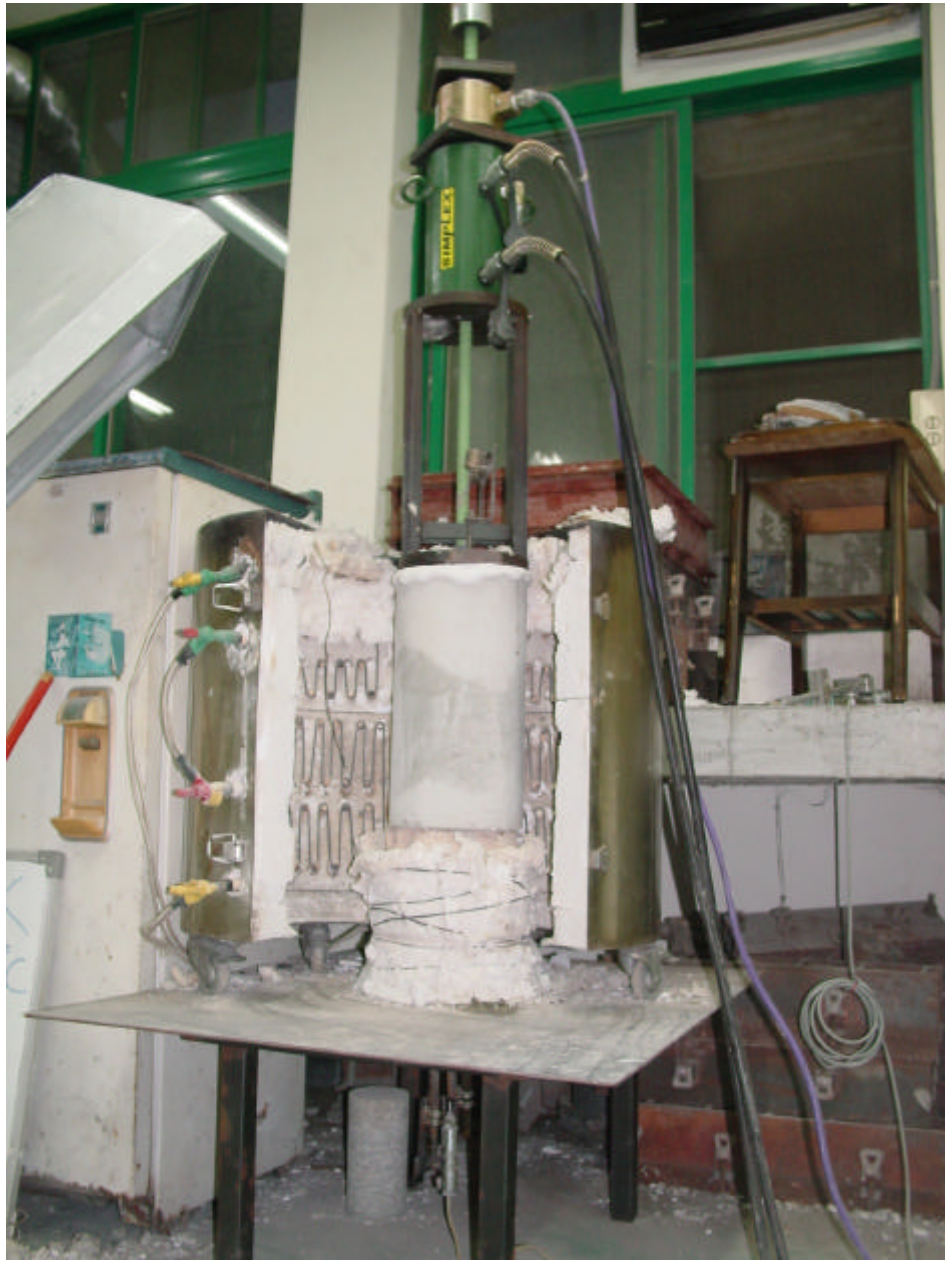
圖（四）握裹力試驗設備（實體圖）
