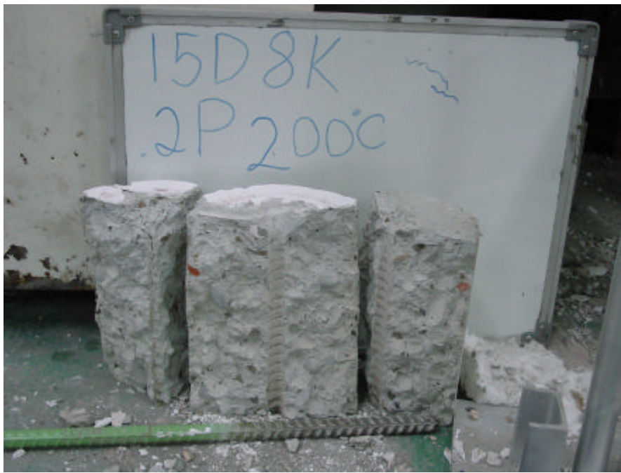
圖(八) 穩態溫度 200 °C 拉拔試驗 試體劈裂情形
