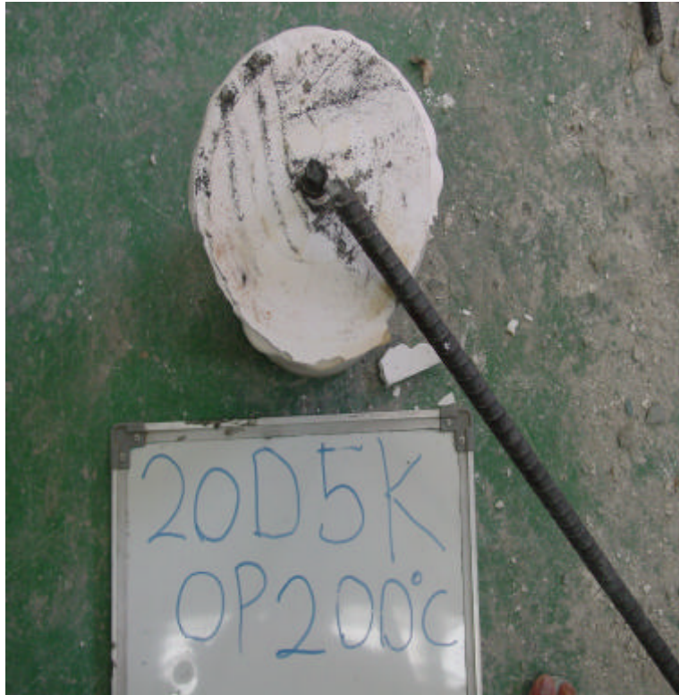
圖(十一) 穩態溫度 200 ℃ 拉拔試驗 試體劈裂情形
