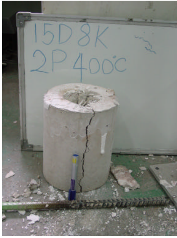
圖(九) 穩態溫度 400 °C 拉拔試驗 試體劈裂情形
