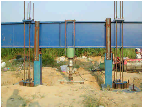
圖十四、現地承載試驗(水平地表條件)
