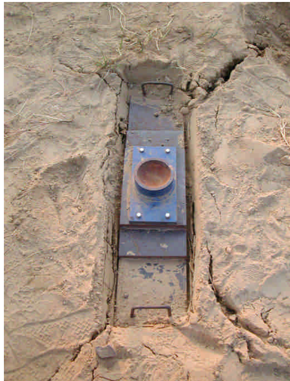
圖十八、基礎破壞模態(水平地表條件)
