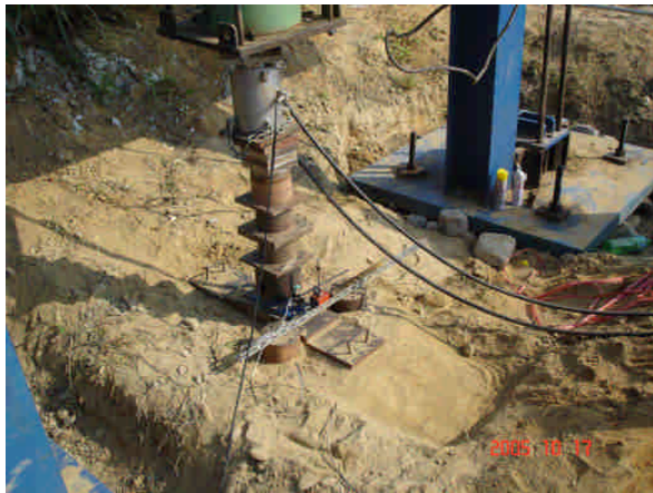
圖十五、現地承載試驗(臨近 20 度邊坡坡頂條件)
