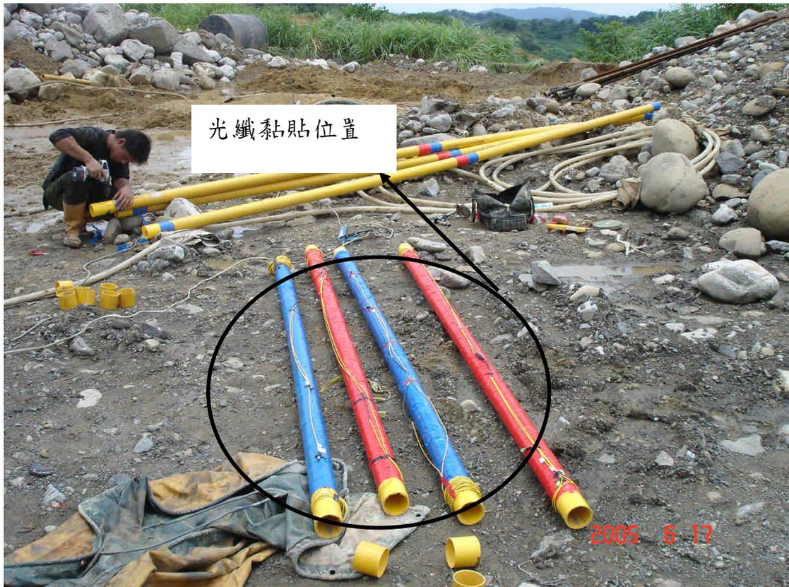
圖 3- 11 (b) 光纖直接黏貼於測傾管上之實體圖
