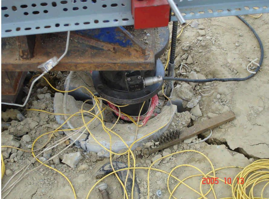
圖 4-4 現地樁載重樁體破壞之實體圖
