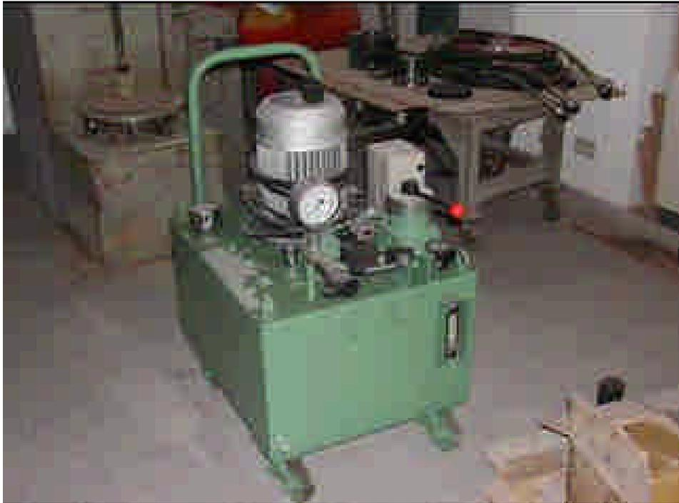
圖 3-6 電動油壓泵(吳政達，2003)
