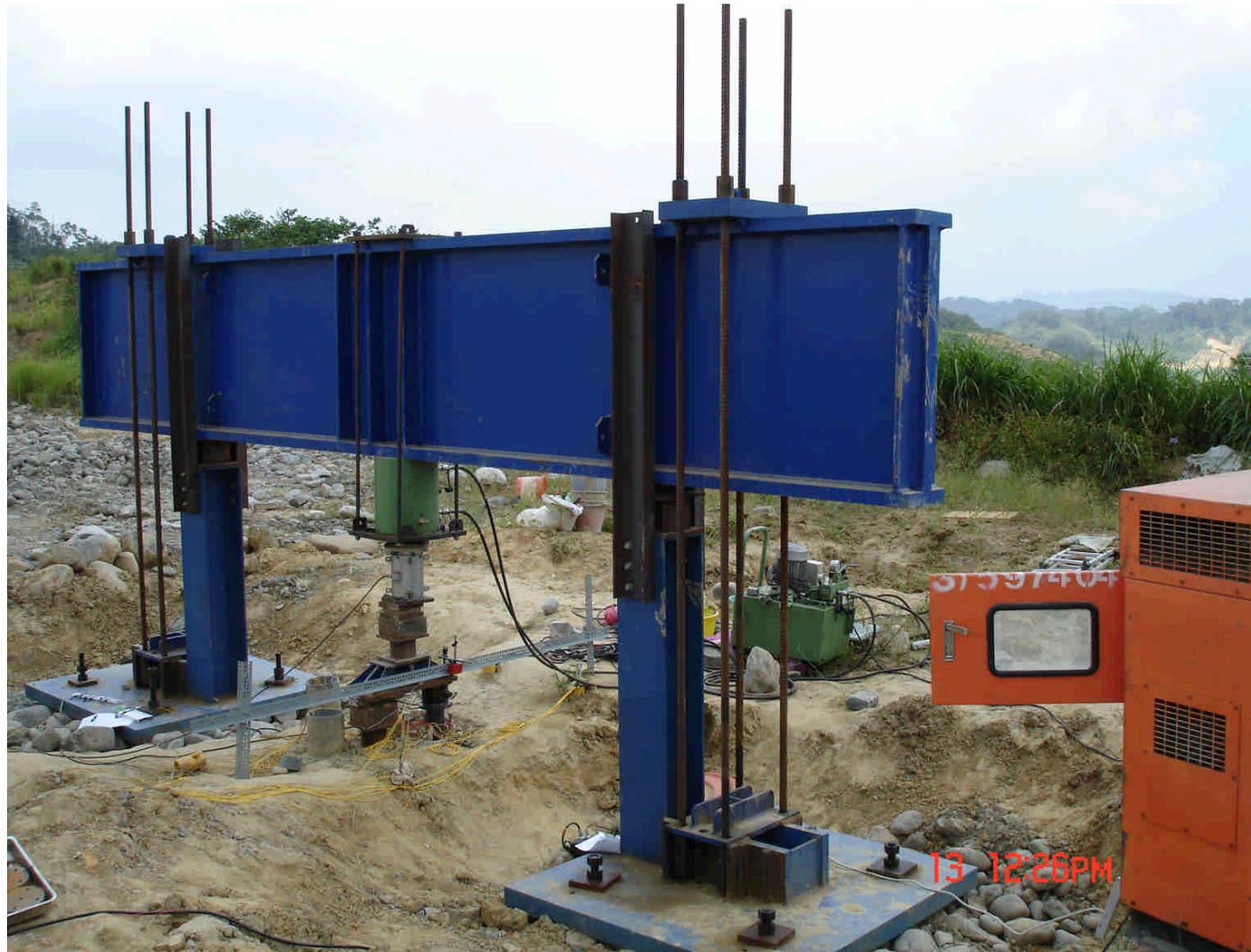
圖 4-1 基樁載重試驗現場照片
