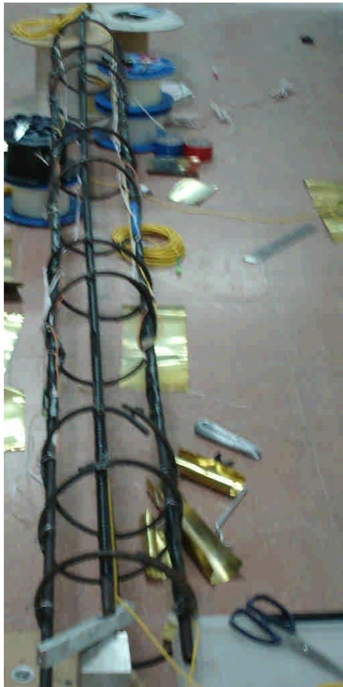
圖 3-3 (c) 樁體之鉚筋籠準備完成後之實體圖
