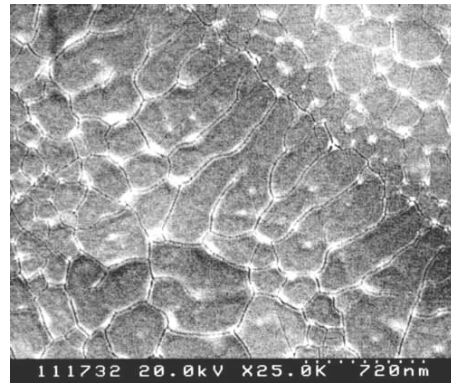
圖(二) 凹槽式結構經準分子雷射結晶後之掃描式電子顯微圖示
