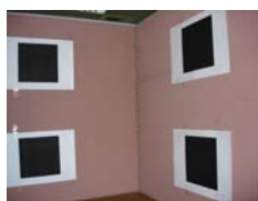
圖10 加入場景的特徵點紙板。其上的特徵角點稱為輔助點。
