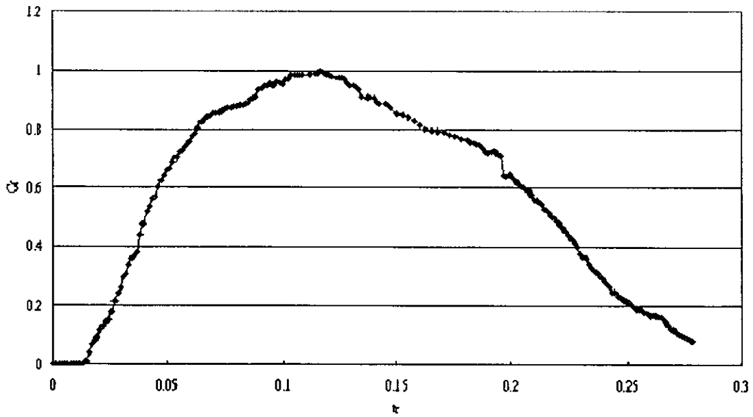
圖 4-107 在 11-1 位置之導電度計量測之 KCl 濃度變化歷線
