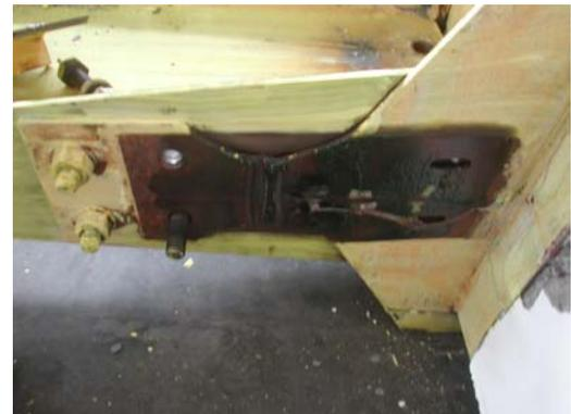
圖 3.12 削切鋼板斷裂
