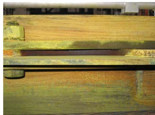
圖 3.14 試體 4 削切鋼板
