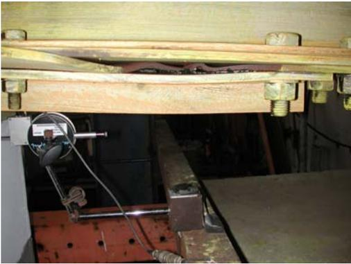
圖 3.11 削切鋼板高模態挫屈
