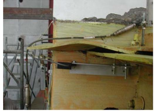
圖 3.10 削切鋼板端部挫屈
