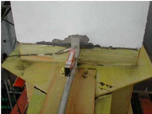
圖 3.9 削切鋼板端部降伏
