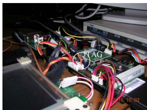
(a)使用 JTAG 介面燒錄 Linux bootloader (b)正確驅動網卡後之開發平台執行畫面 圖 5 在 PCM-7220 開發版上建立與載入 IEEE 802.11b 網卡驅動程式
