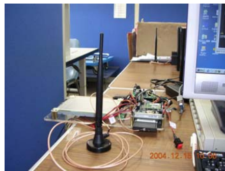
(a)PCM-7220 連接無線網路 (b)外接天線進行無線區域網路連接測試情形 圖 6 測試與驗證 PCM-7220 無線網路模組功能
