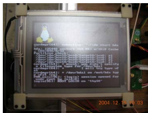
(a)使用 JTAG 介面燒錄 Linux bootloader (b)正確驅動網卡後之開發平台執行畫面 圖 5 在 PCM-7220 開發版上建立與載入 IEEE 802.11b 網卡驅動程式
