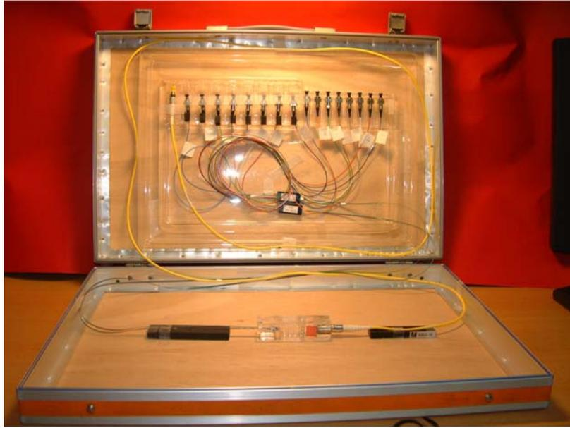
圖 12 封裝後十六通道的分波解多工系統實體照片。
