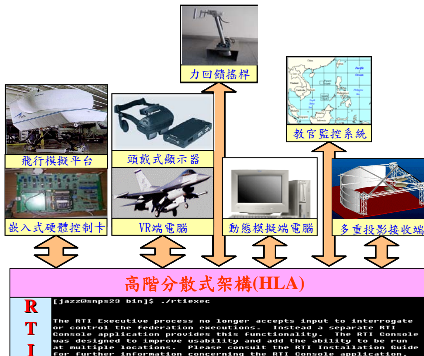
圖 1 飛行動態模擬系統完整架構圖
