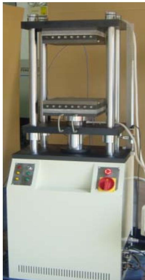
圖一 微電腦控制熱壓機
