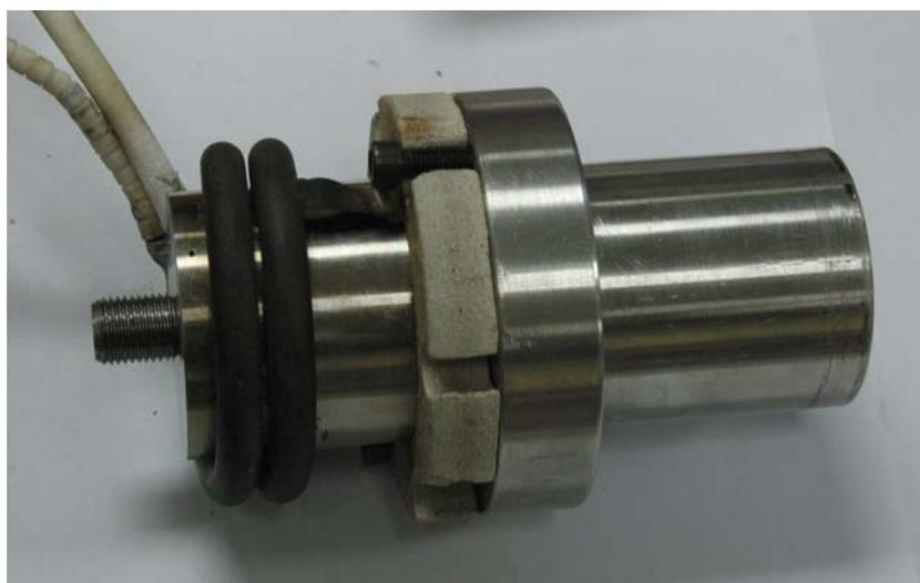
圖四 螺旋管輔助加熱裝置之共振器
