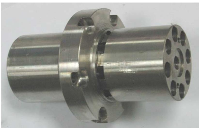
圖五 多孔式共振器設計
