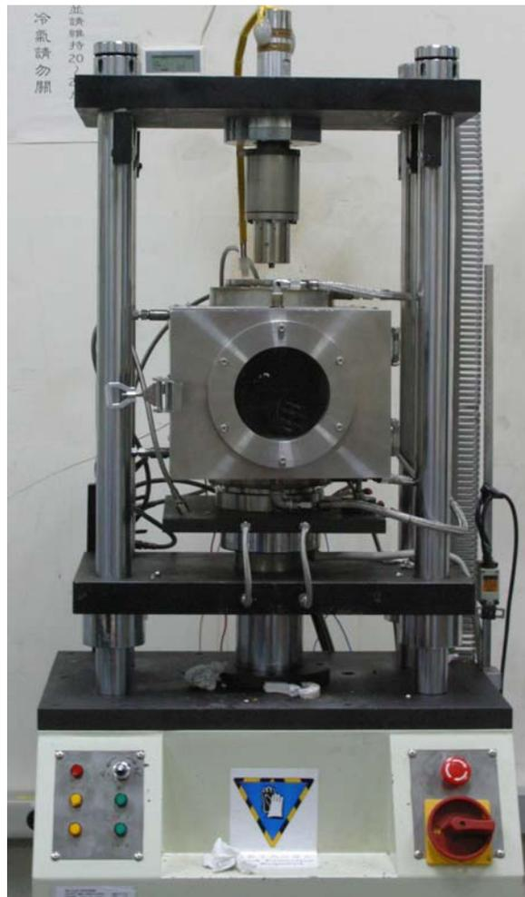
圖六 超音波輔助之壓縮試驗實驗裝置
