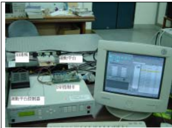
圖(二) 加速規式位置感測器實驗測試設備
