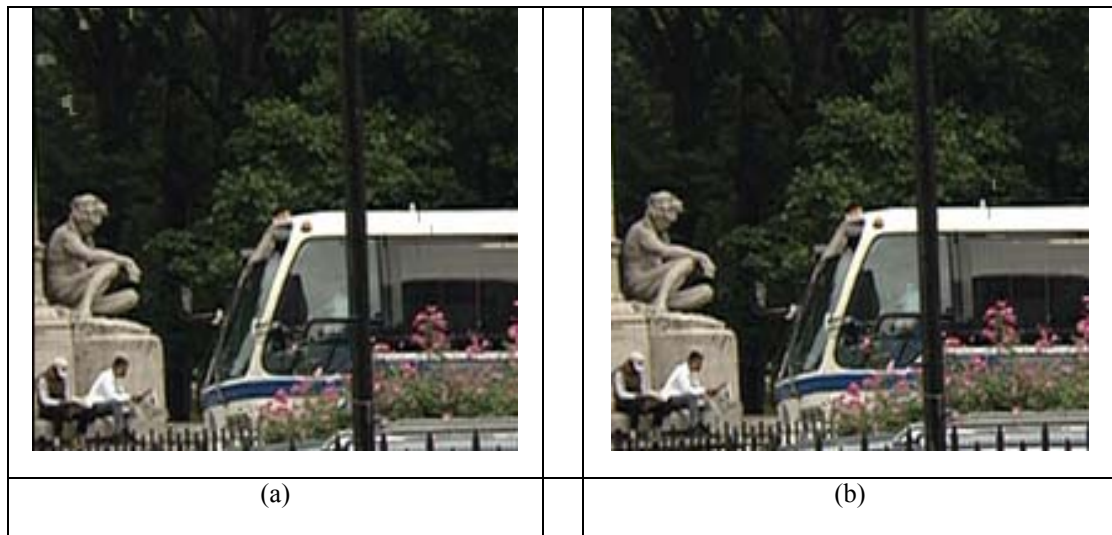
圖 25: 第二時間軸階層之低通影像比較：(a)無 I-block 技術 (b) 利用 I-block.
