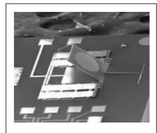
圖二 微光面鏡的 SEM 照片
