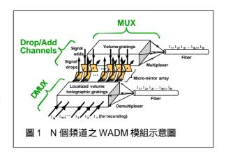
的微面鏡組成,如果是要下載(Drop)該頻道的信號,則該頻道的第一個微面鏡豎起來跟光束成 45 度角,於是該頻道的光就被反射出來而下載了; 如果不下載則這一對微面鏡組平躺,而使光束直接打入第二塊體積光柵(MUX)中而被繞射進入下一段光纖,於是讓該頻道的信號在光纖網路中直通(pass through); 如果想要上載(Add)某一頻道信號時,則把信號垂直射入該頻道的微面鏡組的第二微面鏡,面鏡豎起 45 度,於是光束被反射到水平方向射向後半部的體積全像光柵濾波器(MUX),經過光柵繞射之後加入光纖而向下一段傳播;於是,經由濾波器將各個頻道的光波分到各頻道,再經由控制微面鏡的豎直或躺平就可以達到光束下載或上載的功能。
