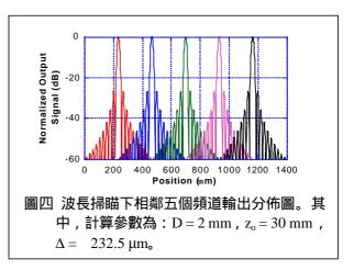
按照這樣的參數,兩個頻道之光柵間隔約 0.25mm,則一塊長度為 2.5 公分的光學晶體或體積全像記錄材料,將可以容納 100 個頻道,構成一個結構緊緻的 DMUX 與 MUX,相當有意思。其中的關鍵問題,是現今仍缺乏在紅外線波段感光的材料,以及可以在局部材料記錄個別光柵而其他部位不會感光,以達到眾多光柵全部記錄在一塊體積之全像光學記錄材料。因此,上述的實驗及研究都是在可見光範圍進行,目前研究中的感光高分子材料以及雙波長感光記錄的光折變晶體則是正在努力的方向。
