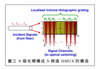
現在探討雜訊問題。在 DWDM 光通信系統,許多波長的光信號同時在一根光纖之中傳播,這些光波通過光柵時,雖然只有波長滿足布拉格條件的光波會被繞射到對應的頻道,但其他波長的光也會有少量繞射而產生雜訊,變成頻道之間的噪聲互擾,所有其他波長的光波在第i個頻道的繞射雜訊之振幅總和可寫成
