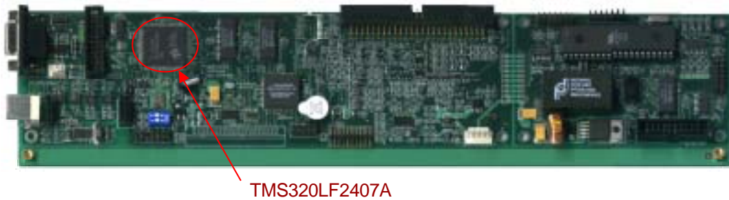
圖 7.4 研製完成的 PV inverter DSP 數位控制器
