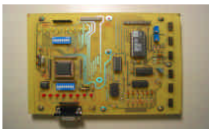
圖九 CAN bus 實際之控制電路板
