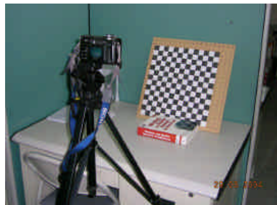
Fig. 36 計算轉換矩陣之裝置。
