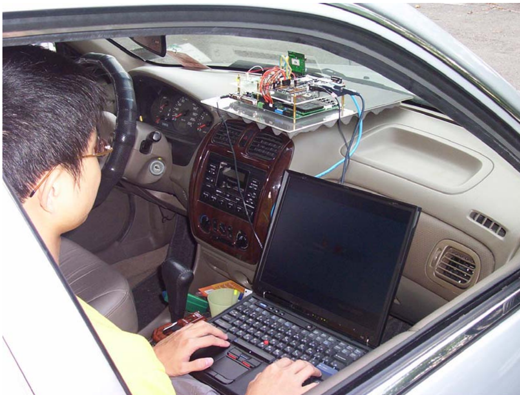
圖 34 影像追蹤系統置於實車內之情況
