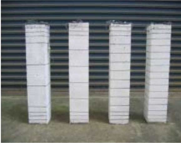
照片一 SRC 柱試體箍筋配置示意圖：H12 系列 (各試體之箍筋量計算法由左而右分別為：PROP<sub>AISC</sub>、AISC、PROP<sub>ACI</sub>、ACI)
