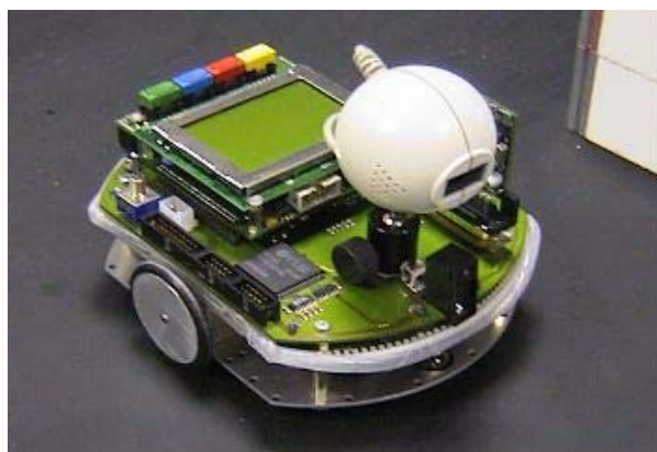
圖五：EyeBot, Prof. Thomas Brauml, Mobile Robot Lab 所設計之移動式機器人
