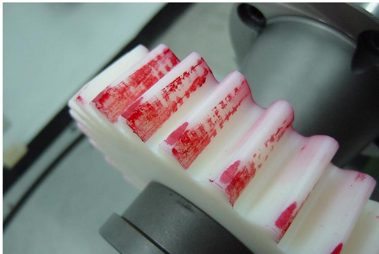
圖 4.16 平行軸漸開線圓錐齒輪之嚙合齒印
