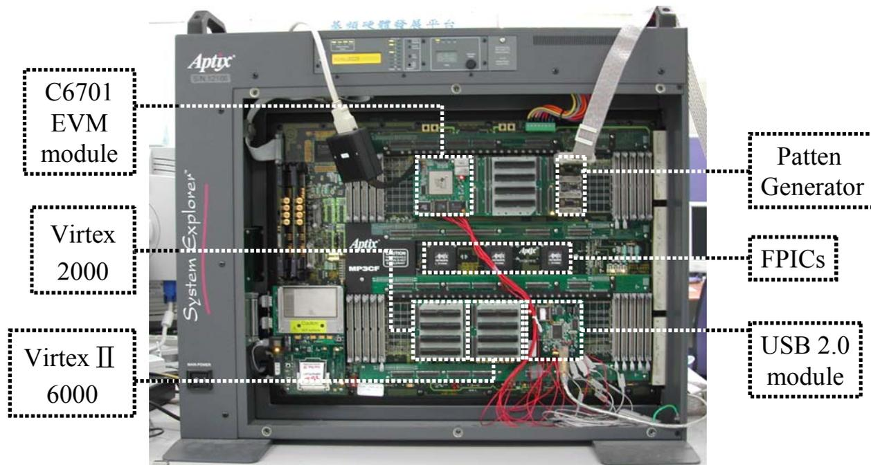
圖 3.2 Aptix System Explorer MP3C 實體圖
