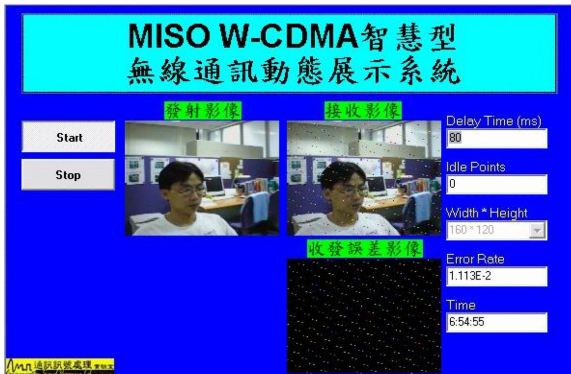
圖 4.31 使用單根傳送天線之動態影像傳輸圖，其 BER 為  $1.13 \times 10^{-2}$
