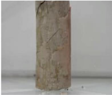
圖15 破壞試體45度裂紋
