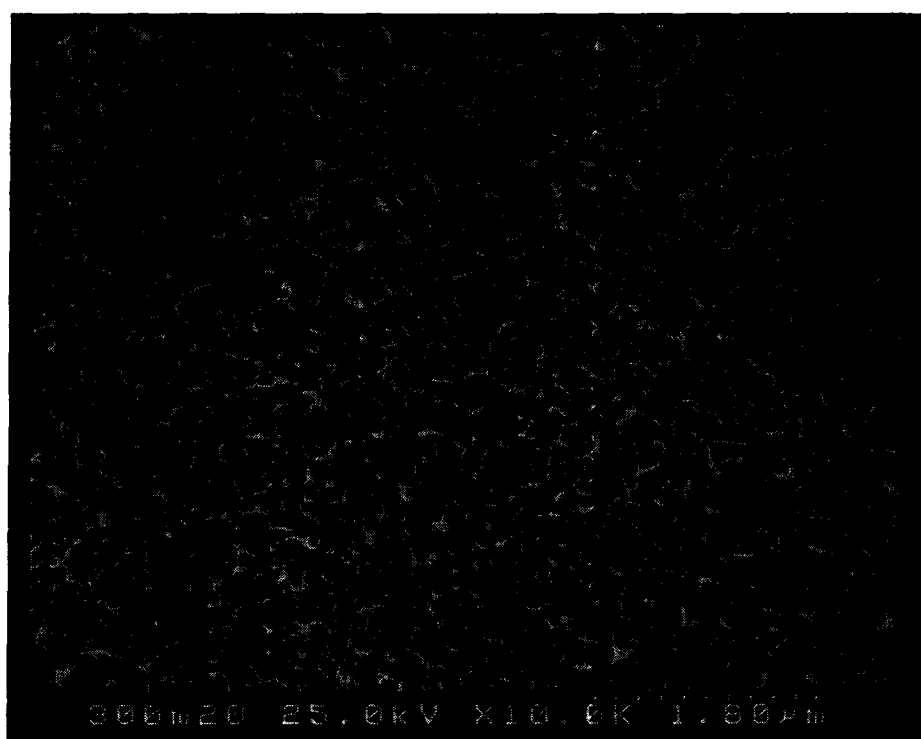
圖十一 (d)、電化學沉積電極薄膜表面 20 min 300°C
