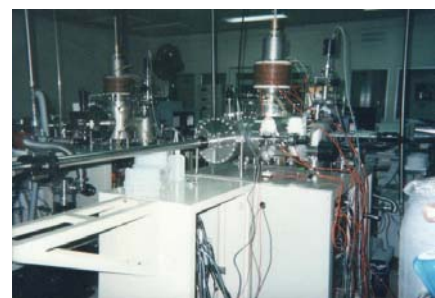
圖一、自行研發之電子迴旋共振化學氣相沉積系統 (ECR-CVD) 示意圖，用以成長 1.0 nm 超薄氧化層，並進行氮化處理。
