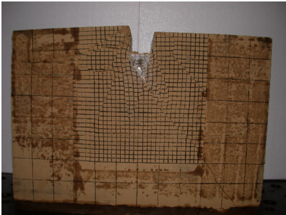
圖四、第一顆承載試體破壞模式及荷重-沉陷曲線
