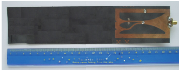
圖五、天線及寬頻微帶線平衡-不平衡 實體照片，(a)正面(b)背面。
