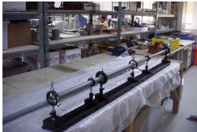
圖五 將 FBG 黏著於管件時所使用之光學軌。
