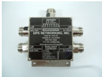
圖 2-2 1 對 4 之功率分流器 (是用微帶電路設計而成，其設計具有二路訊號對稱性，即功率相同、相位相同)
