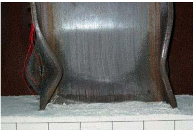
照片六 試體 SRC3 之鋼梁塑性變形情形
