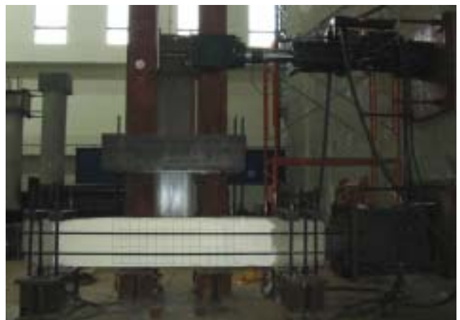
照片三 SRC 梁柱接頭實驗架設圖
