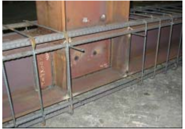
照片一 試體 SRC5 之接頭區加銲疊合板
