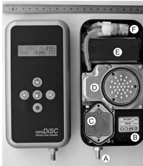
圖 3.1.3.5 微型擴散粒徑篩選儀(左)外殼、(右)內部.真實圖片，(a)空氣入口、(b)高電壓組件、(c)單極充電器、(d)過濾濾材、(e)電池和(f)馬達 (Fiertz et al. 2011)
