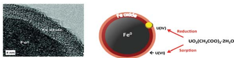
圖 3.1.2.25 奈米零價鐵之殼核結構 TEM 分析；奈米零價鐵去除六價鈾之示意圖 (Gray et al. 2012)
