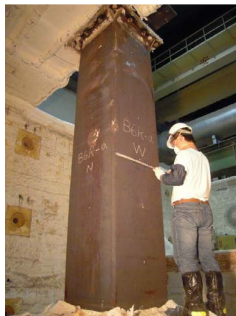
圖 4-44 試體 B6Ra-3 耐火試驗後之外觀
