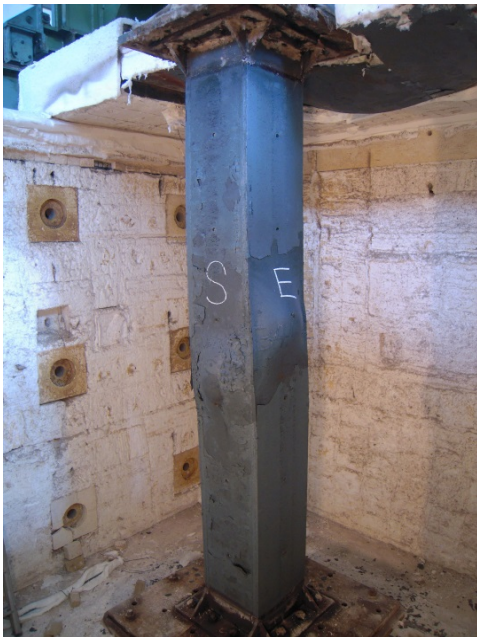
圖 4-22 試體 B4R-.2 耐火試驗後之外觀
