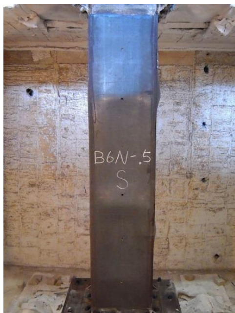
圖 4-15 試體 B6N-.5 耐火試驗後之外觀
