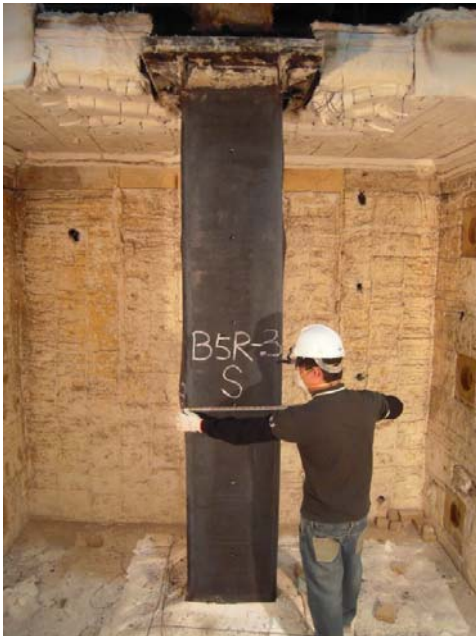
圖 4-42 試體 B5R-.3 耐火試驗後之外觀
