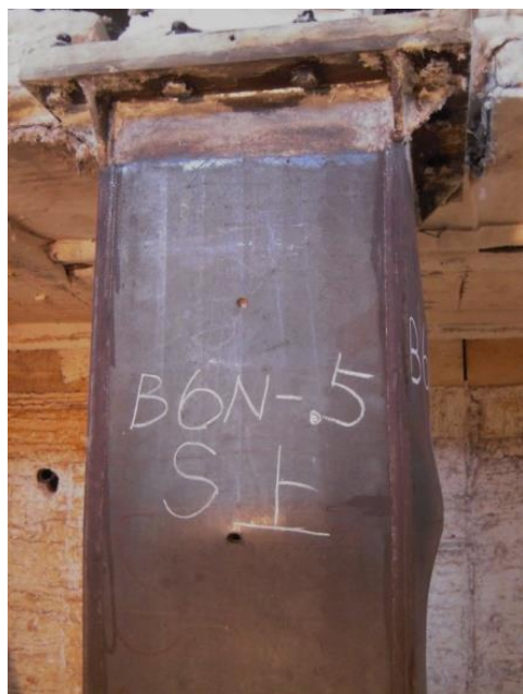
圖 4-16 試體 B6N-.5 局部挫屈
