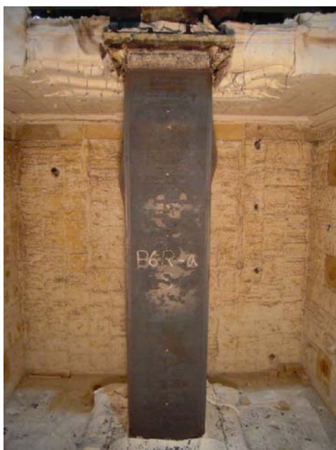
圖 4-44 試體 B6Ra-3 耐火試驗後之外觀
