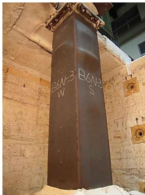
圖 4-10 試體 B6N-.3 耐火試驗後之外觀
