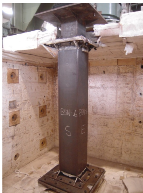
圖 4-5 試體 B5N-6 耐火試驗後之外觀
