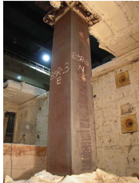
圖 4-42 試體 B5R-.3 耐火試驗後之外觀
