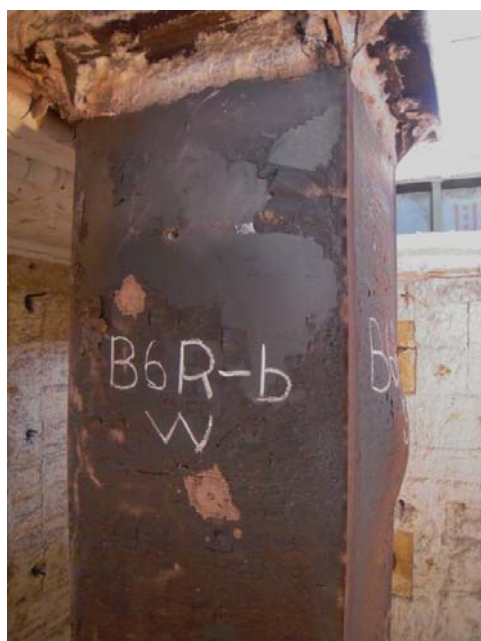
圖 4-47 試體 B6Rb-.4 局部挫屈
