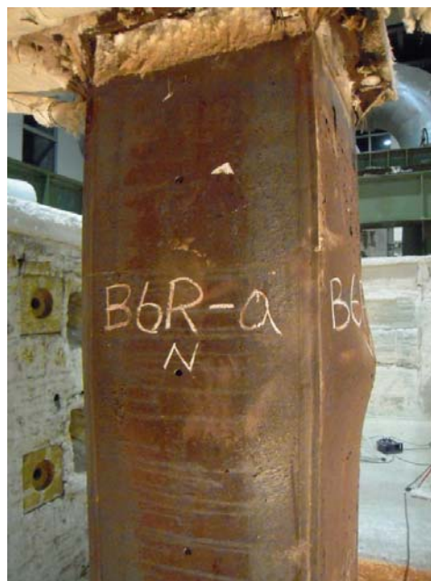
圖 4-45 試體 B6Ra-.3 局部挫屈
