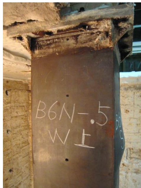
圖 4-16 試體 B6N-.5 局部挫屈
