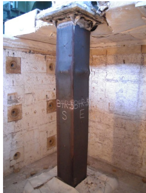
圖 4-30 試體 B4R-.5 耐火試驗後之外觀
