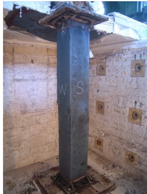
圖 4-22 試體 B4R-.2 耐火試驗後之外觀
