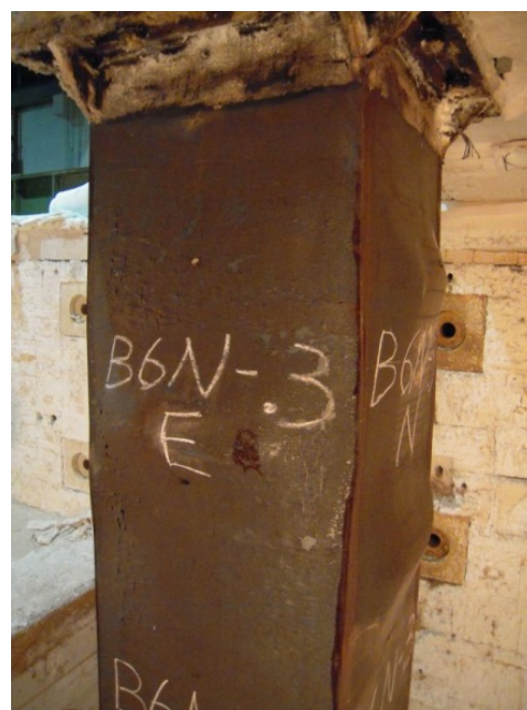
圖 4-11 試體 B6N-3 局部挫屈
