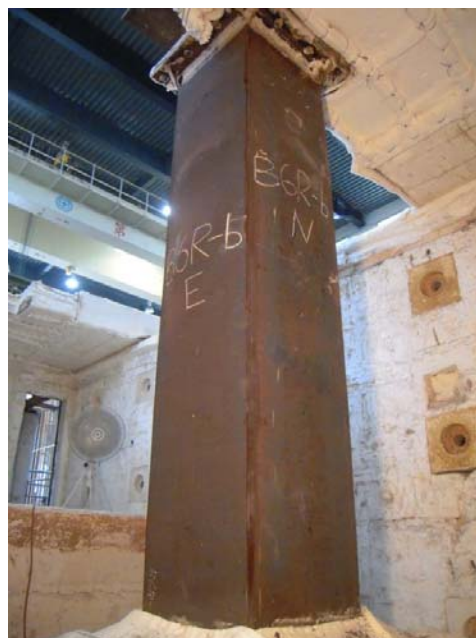
圖 4-46 試體 B6Rb-.4 耐火試驗後之外觀
