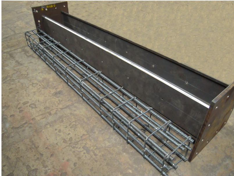
圖 3-5 試體組裝之 U 字形與鋼筋籠示意圖
