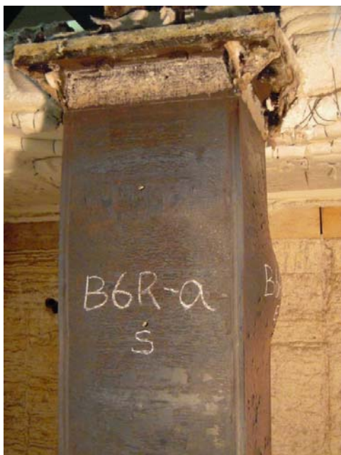
圖 4-45 試體 B6Ra-.3 局部挫屈
