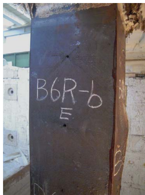
圖 4-47 試體 B6Rb-.4 局部挫屈
