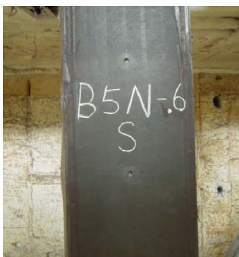
圖 4-6 試體 B5N-6 局部挫屈
