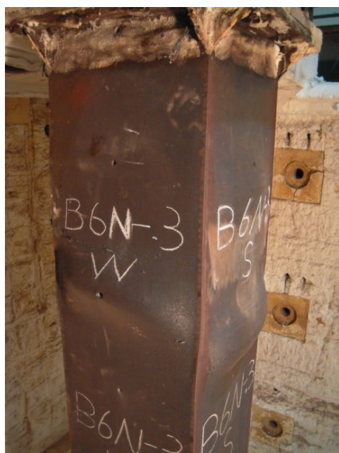
圖 4-11 試體 B6N-3 局部挫屈
