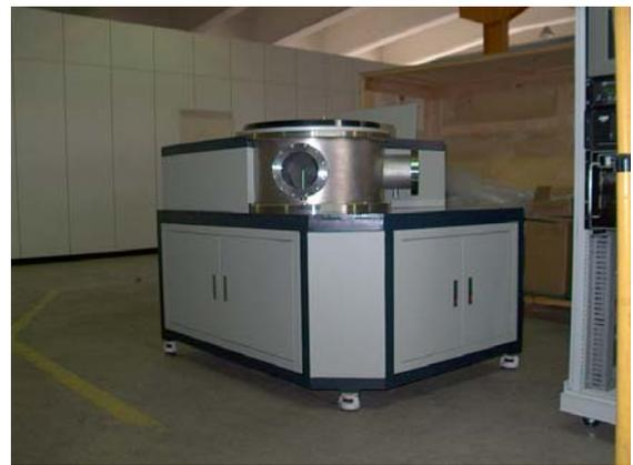
圖 6 大型熱電子輔助化學氣相沉積系統
