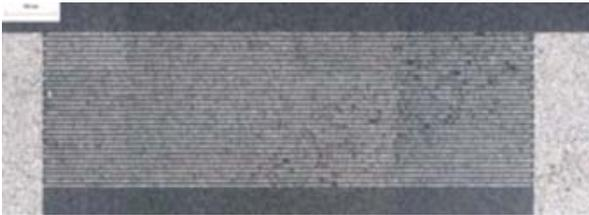
圖 13 光學顯微鏡下的表面聲波濾波器
