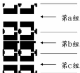
第一層底電極光罩圖形
