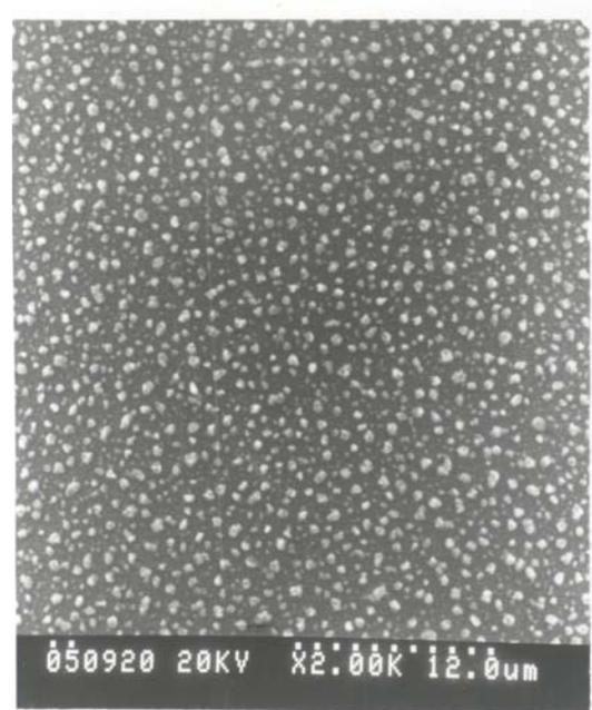
圖 3-2 (a)~(b)依序是編號(4)的樣品其氧化鈦薄膜在未退火處理(as-deposited)的情況下[結構為 amorphous]，鍍於其上的鈮銀銅氧薄膜的 R-T 圖及 SEM 影像；(c)~(d)則依序是編號(4)的樣品其氧化鈦薄膜在溫度為 1000 °C 的退火處理後 [結構為 rutile(110)]，再鍍於其上的鈮銀銅氧薄膜的 R-T 圖及 SEM 影像
