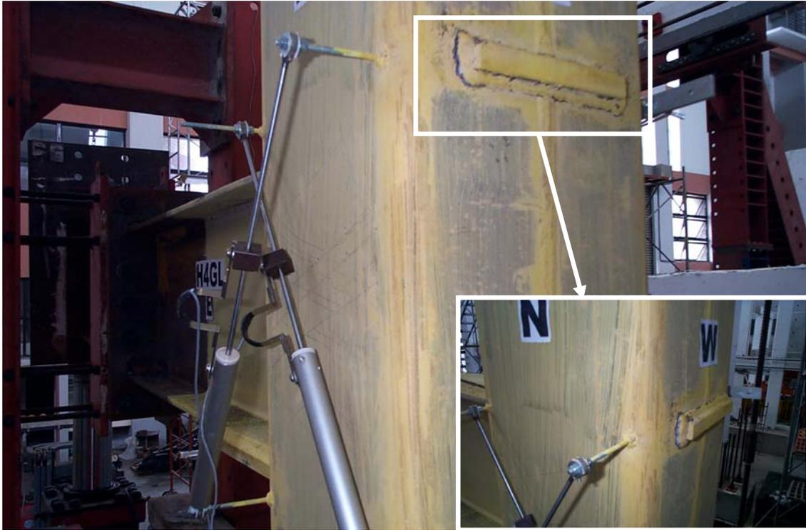
照片 4.11 試體 H4GL 接頭剪力變形與西側貫穿翼板銲道開裂(5% Drift)
