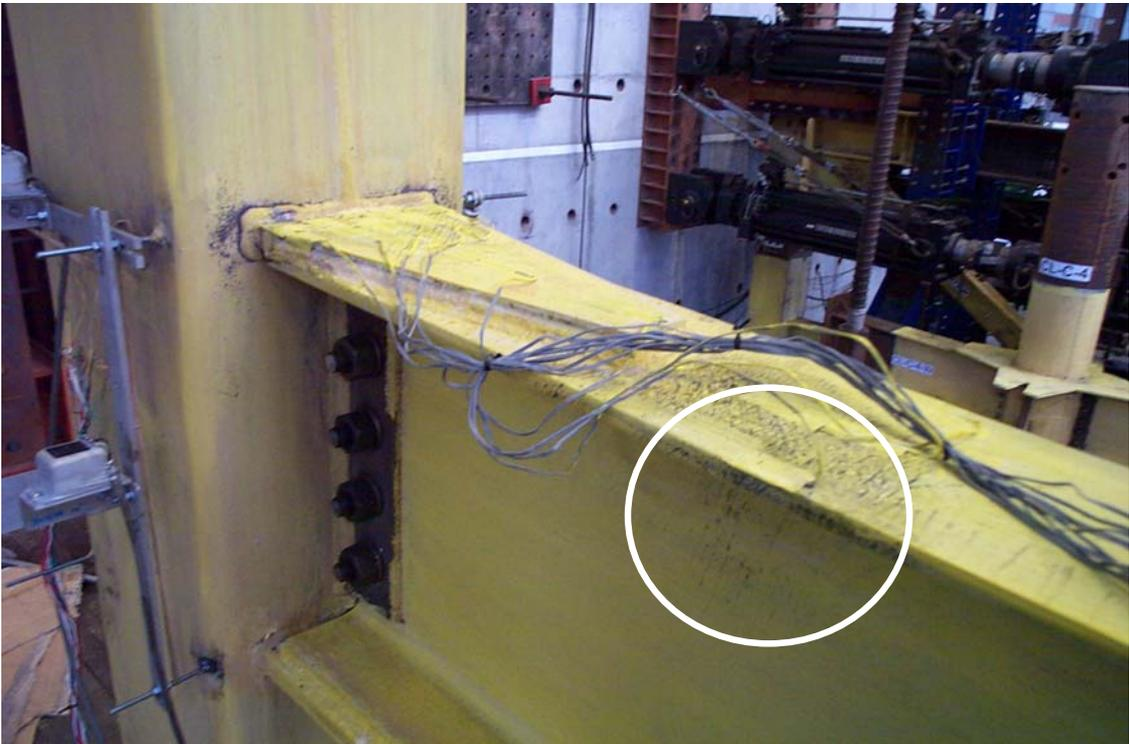
照片 4.4 試體 H4GT 梁翼與梁腹降伏之情形 (5% Drift)
