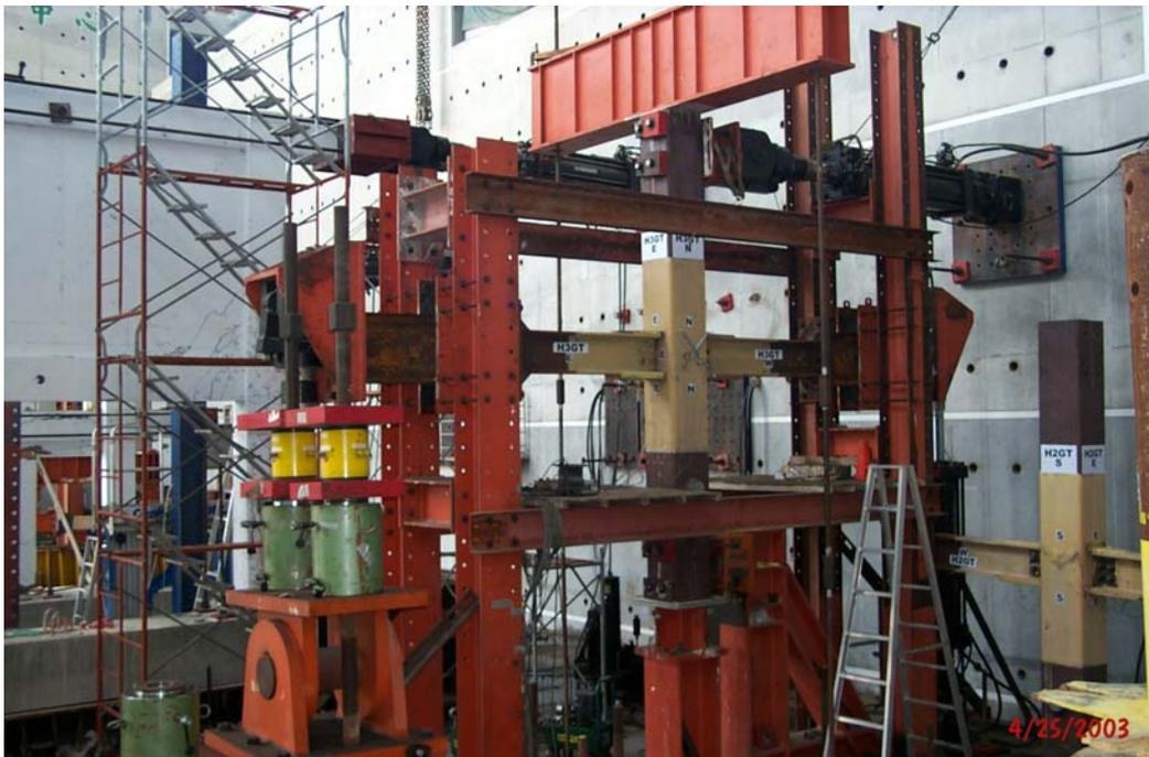
照片 3.2 十字型子結構試驗構架全貌
