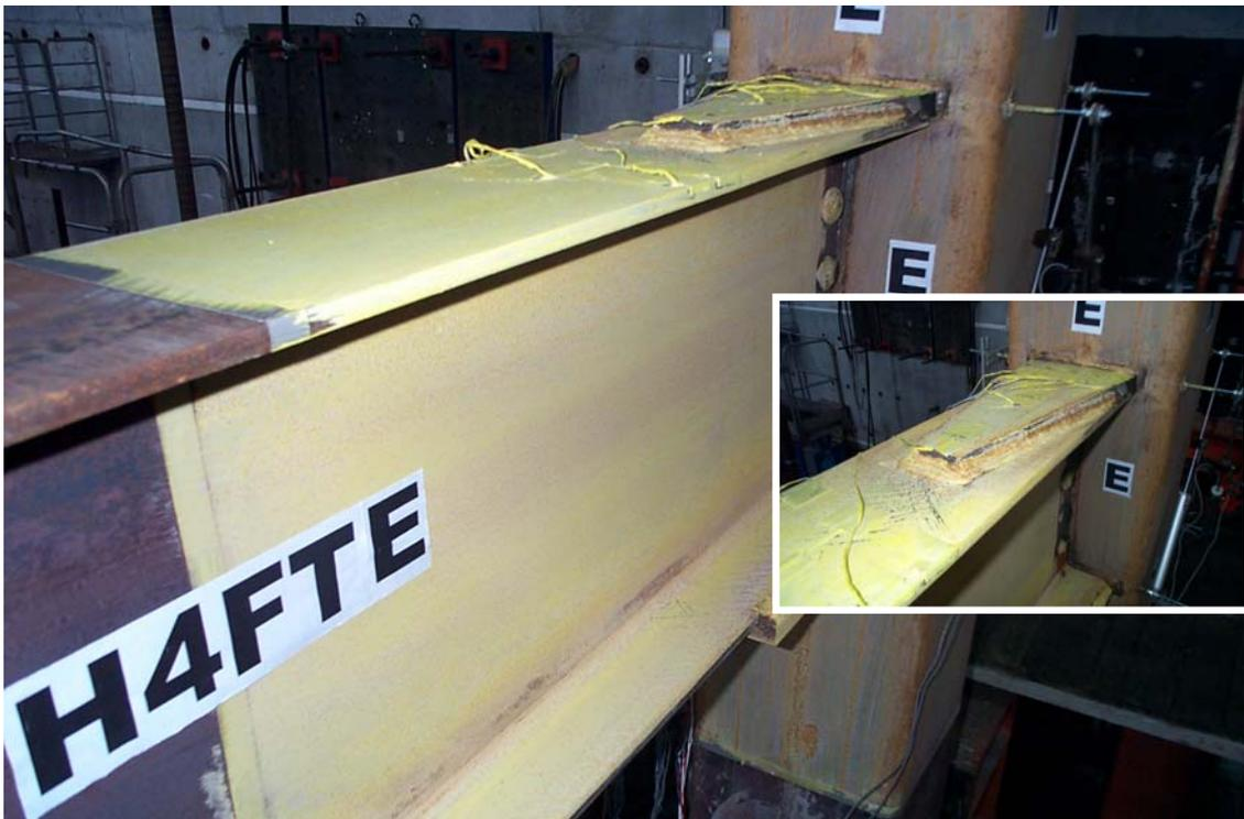
照片 4.16 試體 H4FTE 梁上翼板於貫穿翼板端處降伏之現象 (2% Drift)
