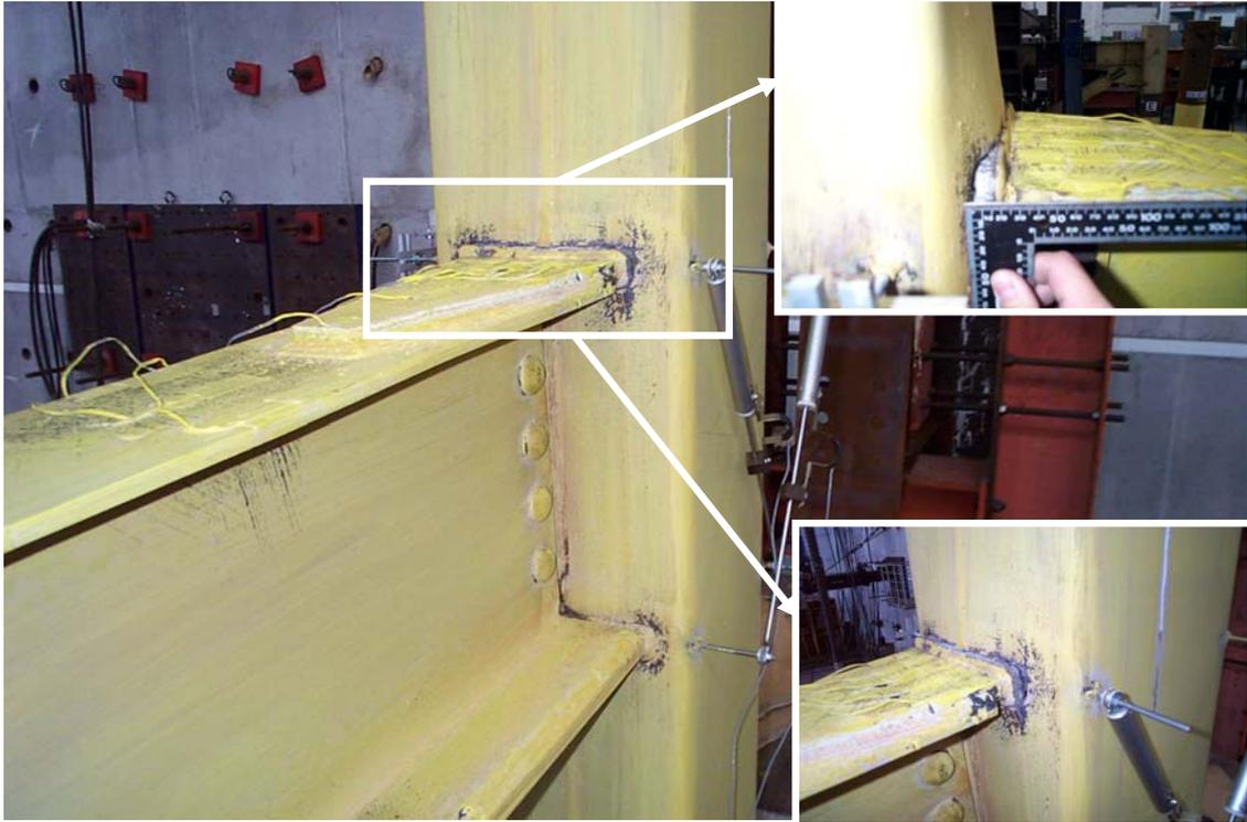
照片 4.7 試體 H4GT 最終破壞情形 (7% Drift)
