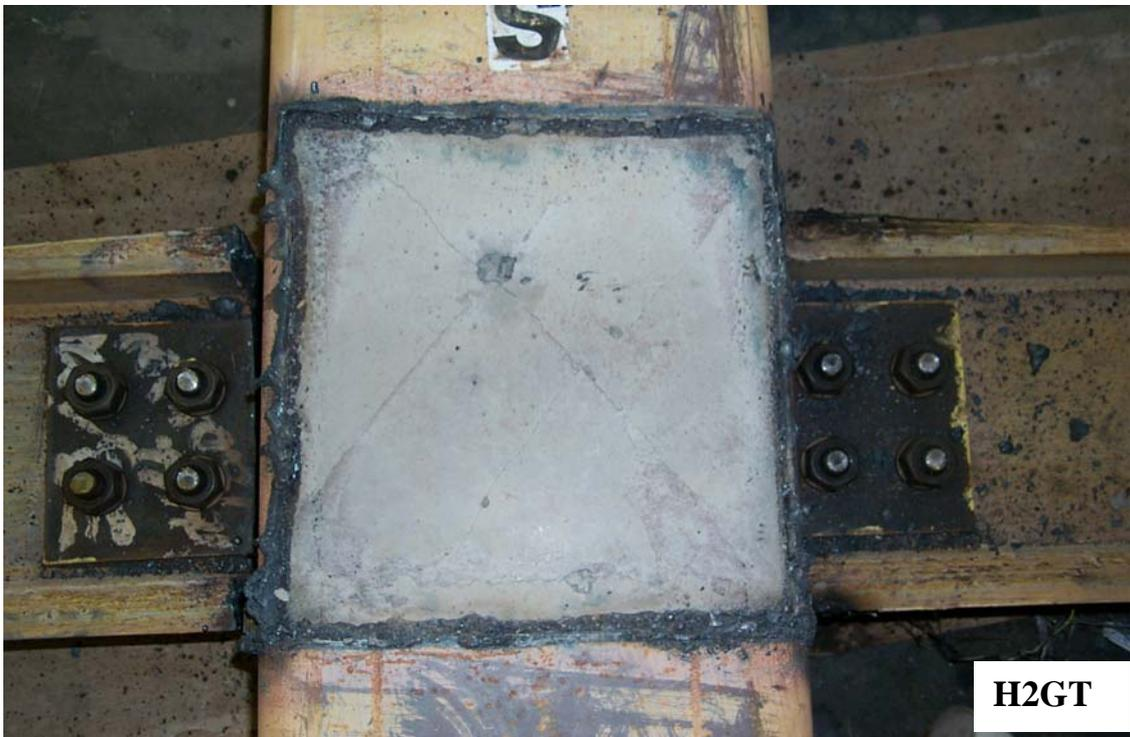
照片 4.30 試體 H2GT 梁柱交會區混凝土剪力破壞之情形
