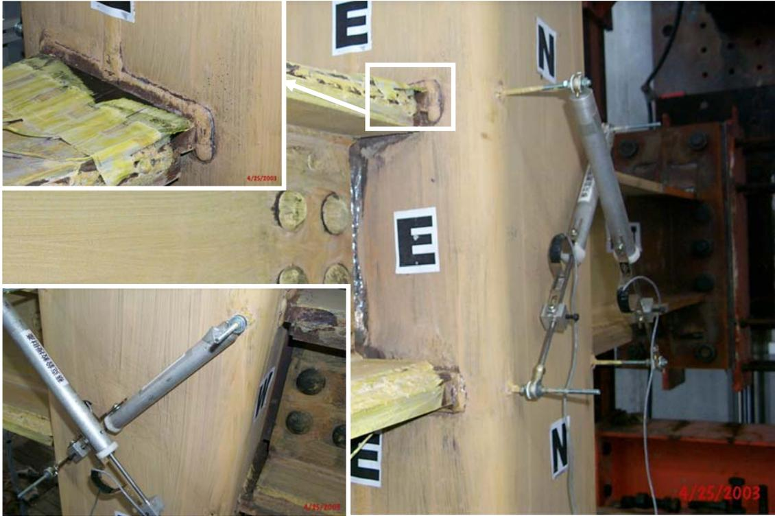
照片 4.27 試體 H3GT 上貫穿翼板銲道開裂與交會區剪力變形(3% Drift)
