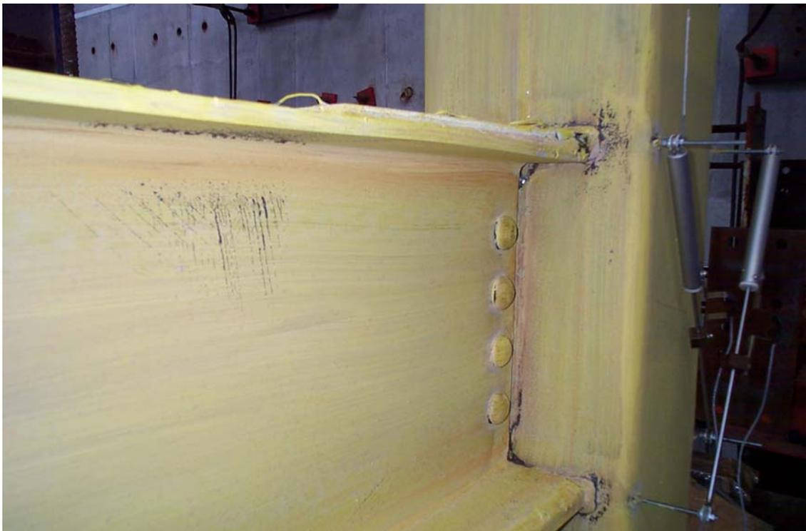
照片 4.6 試體 H4GT 梁上翼板些微挫屈之情形 (6% Drift)
