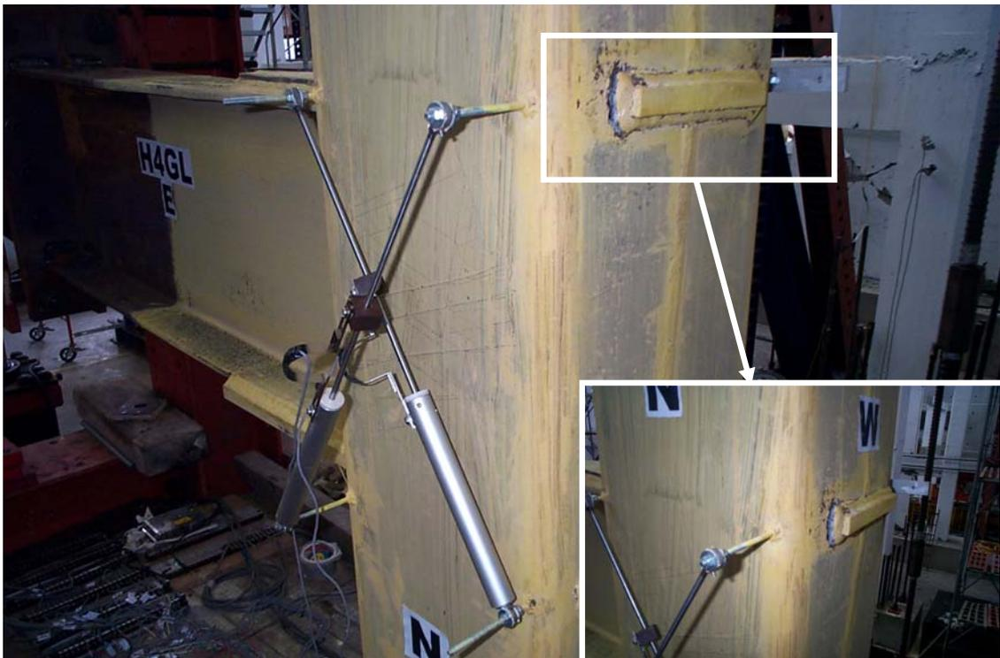
照片 4.12 試體 H4GL 西側上貫穿翼板銲道嚴重開裂 (6% Drift)
