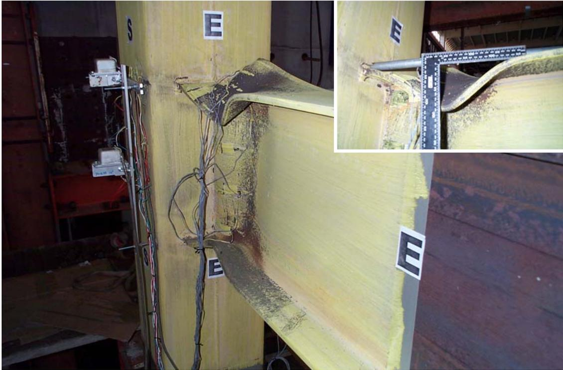
照片 4.23 試體 H4BT 最終破壞之情形 (7% Drift)
