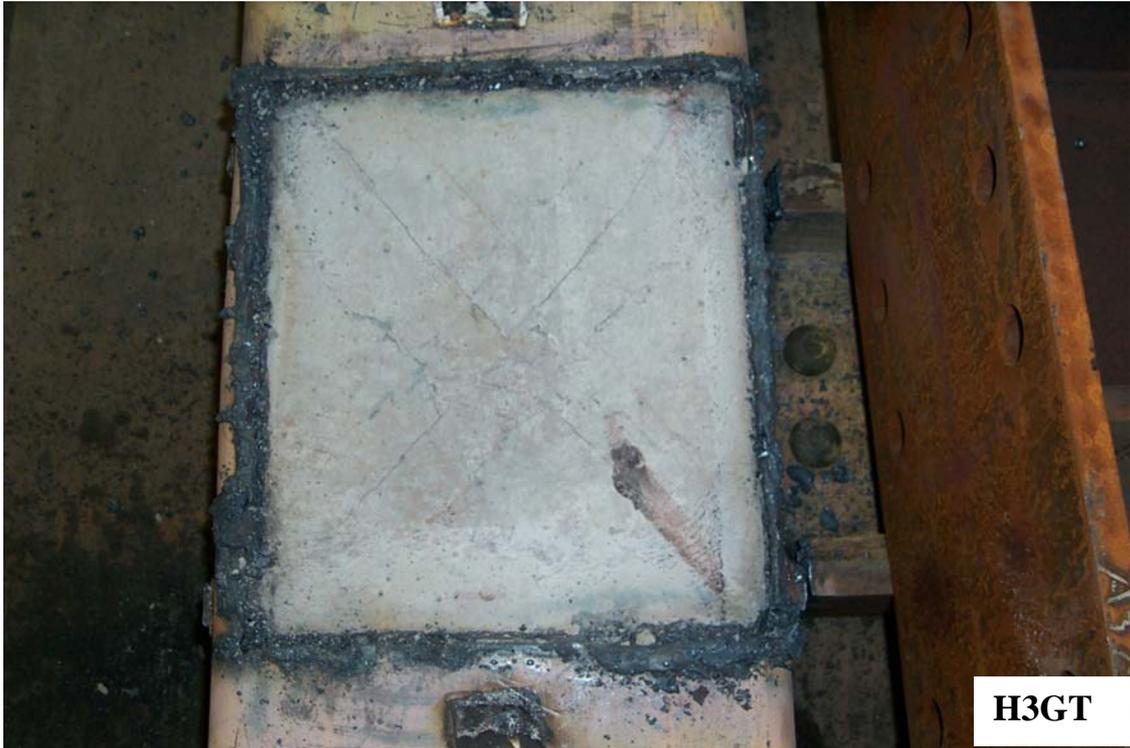
照片 4.31 試體 H3GT 梁柱交會區混凝土剪力破壞之情形
