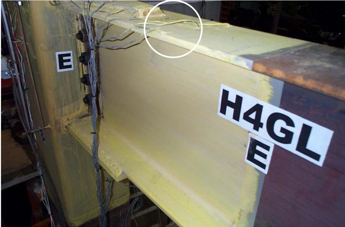
照片 4.9 試體 H4GL 梁翼與梁腹些微降伏之情形 (3% Drift)
