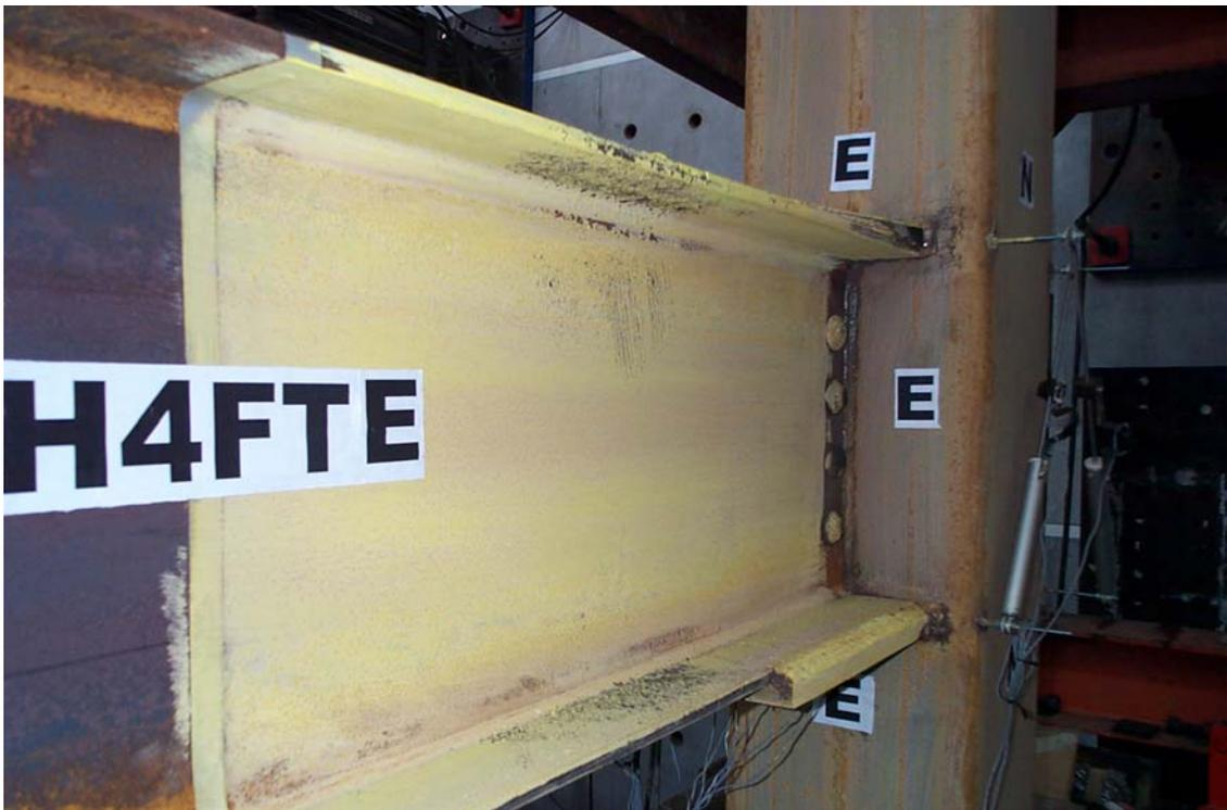
照片 4.18 試體 H4FT 上下梁翼板些微挫屈 (4% Drift)
