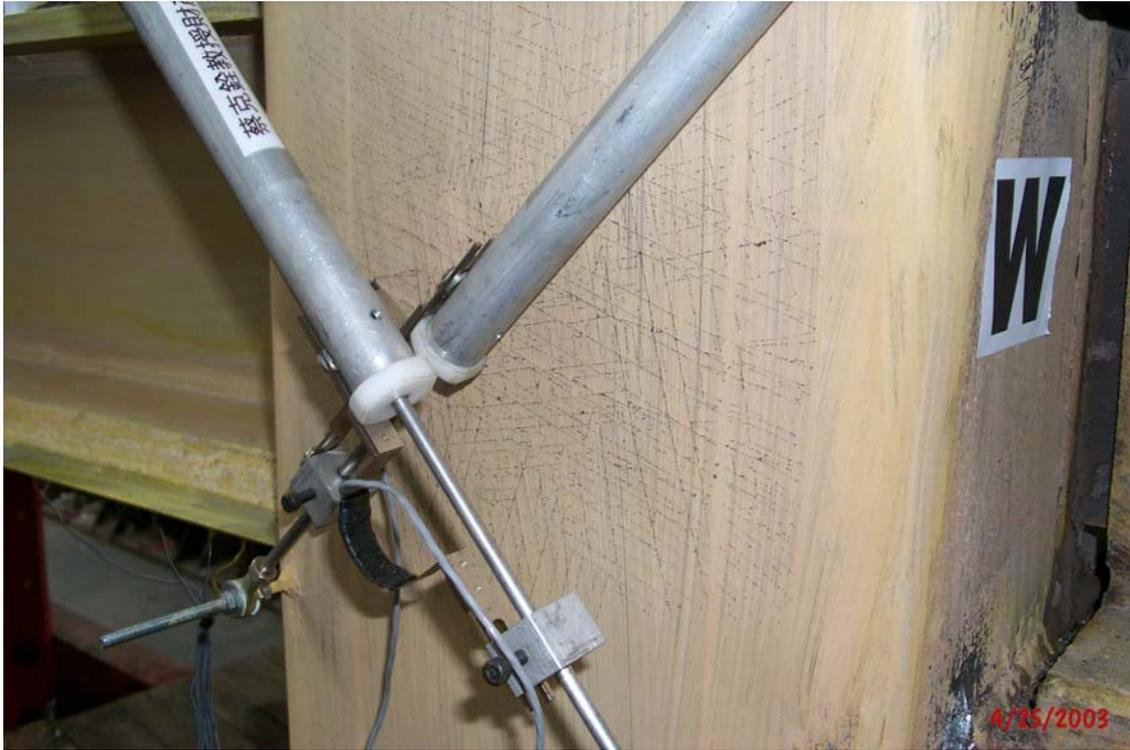
照片 4.29 試體 H3GT 梁柱交會區產生大量剪力變形之情形 (7% Drift)
