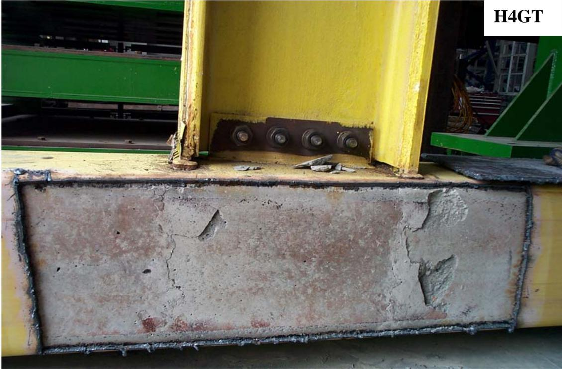
照片 4.33 試體 H4GT 梁柱交會區鋼皮切除後之情形
