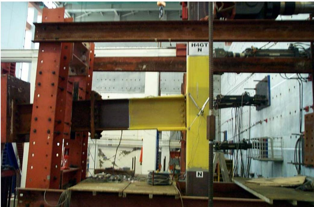
照片 3.4 CFT 鋼管柱與鋼梁塗佈黃色石膏漆之情形
