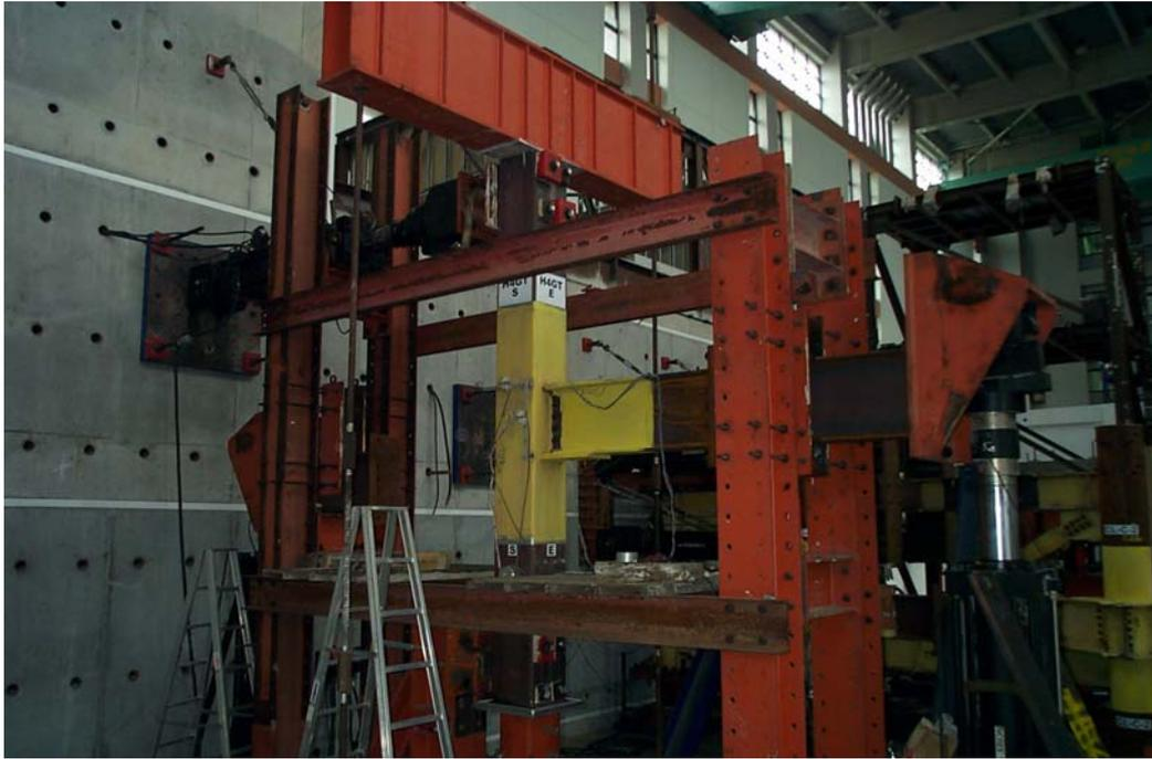
照片 3.1 邊柱子結構試驗構架全貌
