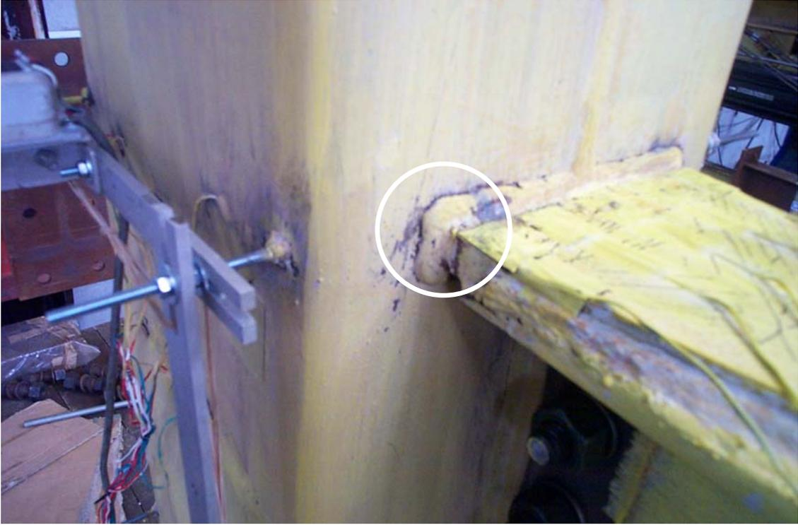
照片 4.3 試體 H4GT 貫穿翼板與 CFT 柱接合銲道些微開裂 (3% Drift)
