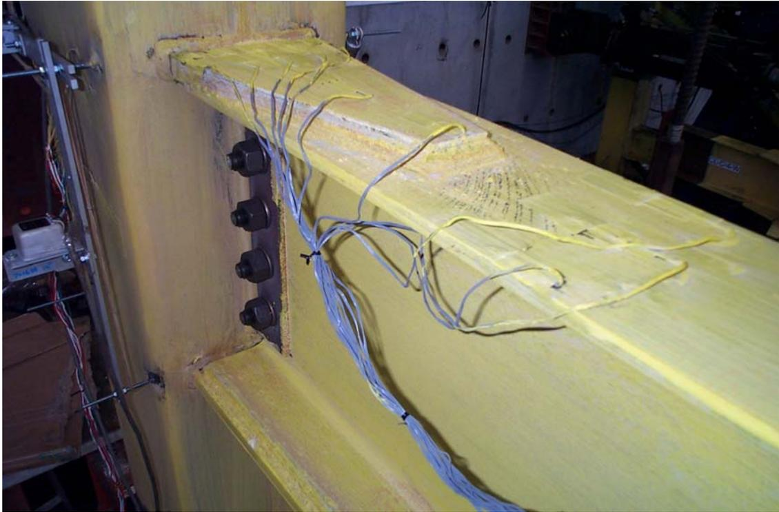
照片 4.1 試體 H4GT 上貫穿翼板端處鋼梁降伏現象 (2% Drift)
