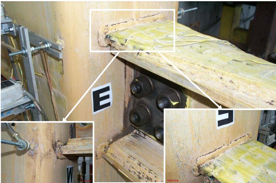
照片 4.24 試體 H2GT 上貫穿翼板銲道開裂情形 (3% Drift)
