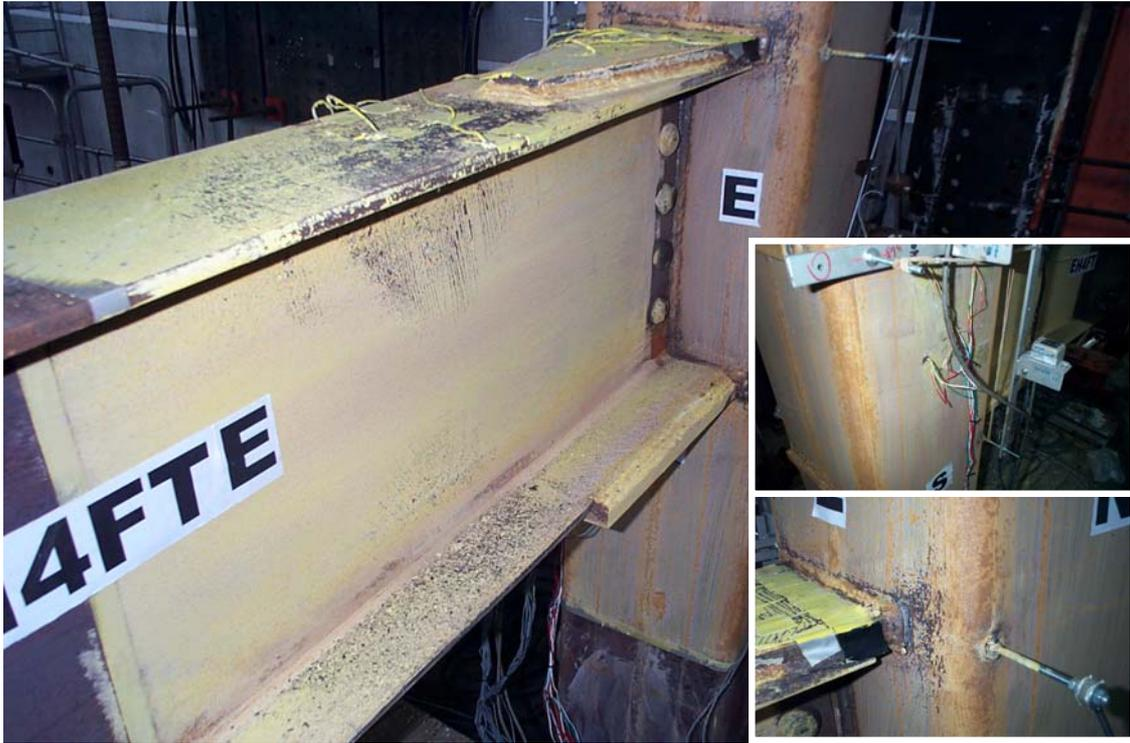
照片 4.19 試體 H4FT 梁翼板明顯挫屈與貫穿翼板銲道開裂 (6% Drift)
