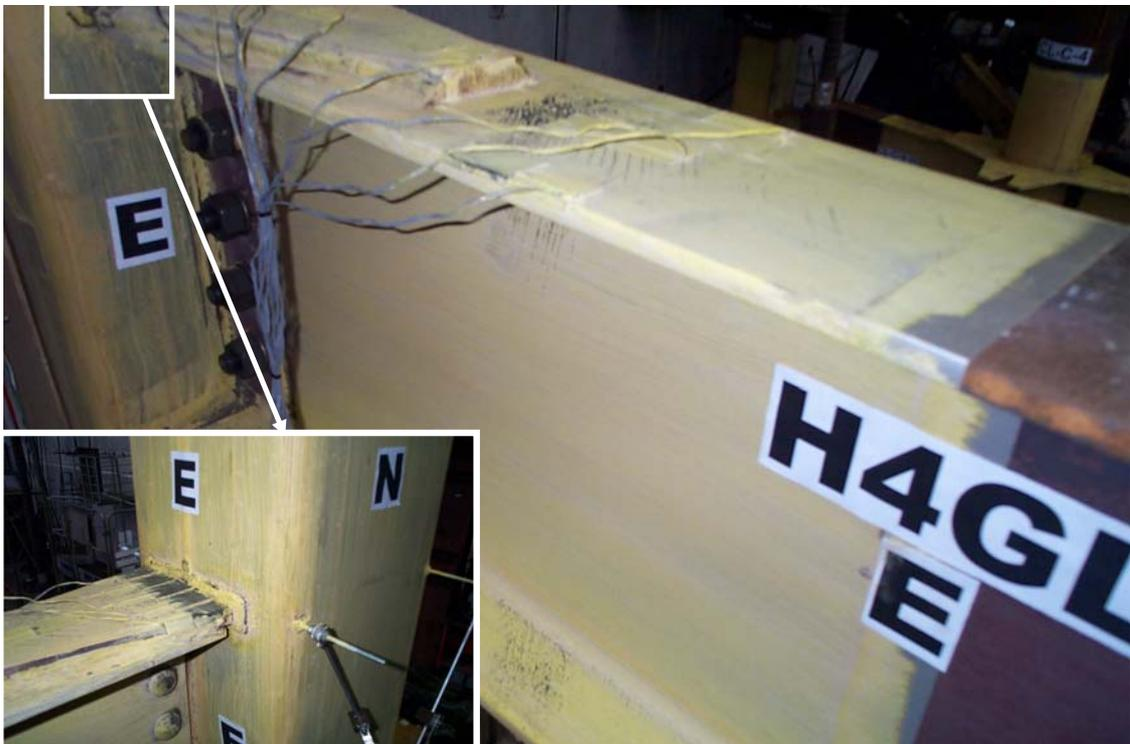
照片 4.10 試體 H4GL 上貫穿翼板銲道開裂與鋼梁降伏之情形(3% Drift)
