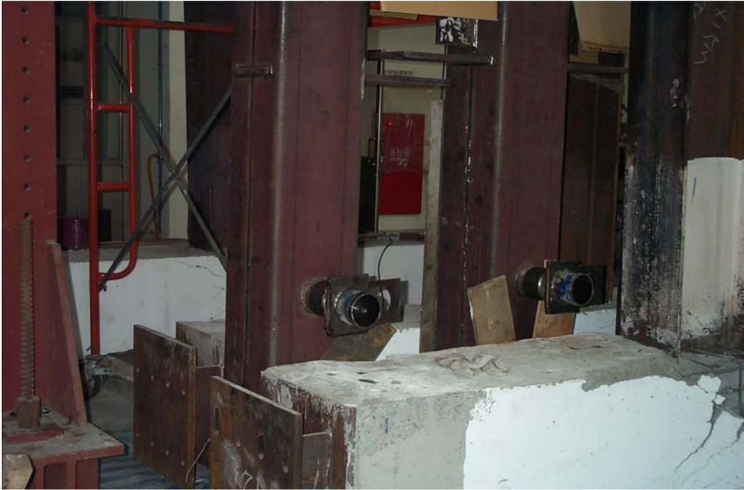
照片 3.3 試體逆止閥之設置情形
