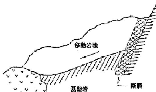
圖 5.18a 末端閉鎖型滑動，風化岩滑動。
