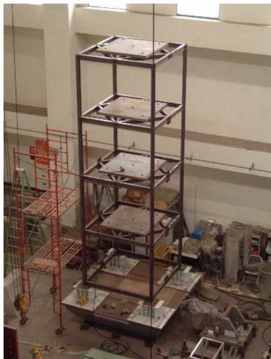
圖 2、四層鋼構模型(未裝設補強肢)
